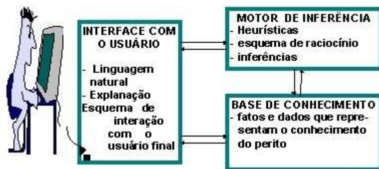
Figura 3. Estrutura básica de um sistema especialista
