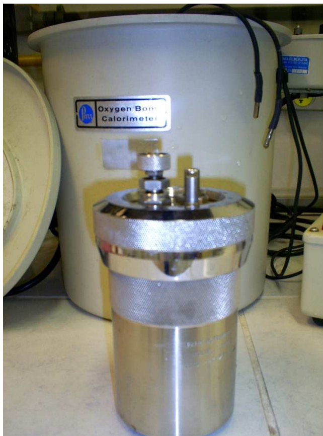
Figura 14: Bomba de combustão Fonte: Fotografia obtida pela autora
