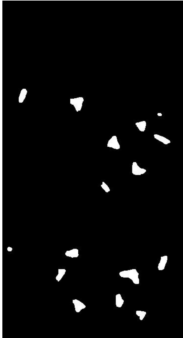
Figura 26 – Imagem após erosão
