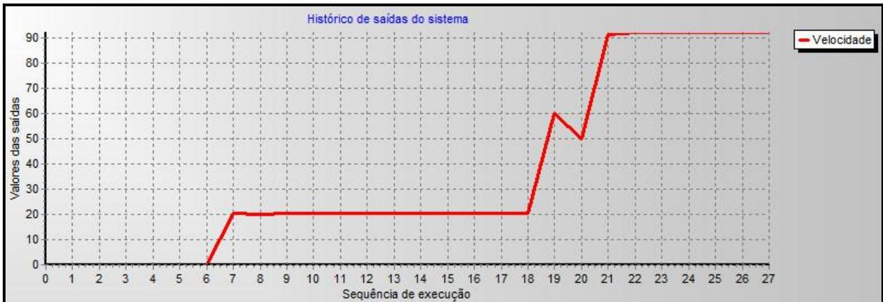
Figura 72- Projeto difuso controle ventilador: Gráfico de saída da variável "Velocidade"
