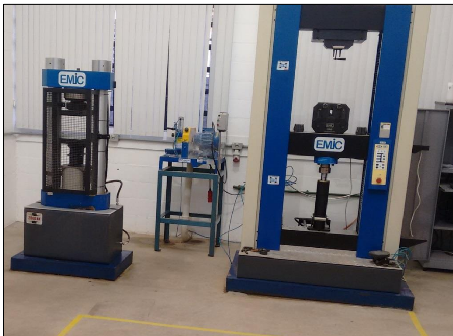
Ilustração 24 – Equipamento sem sinalizações de segurança
