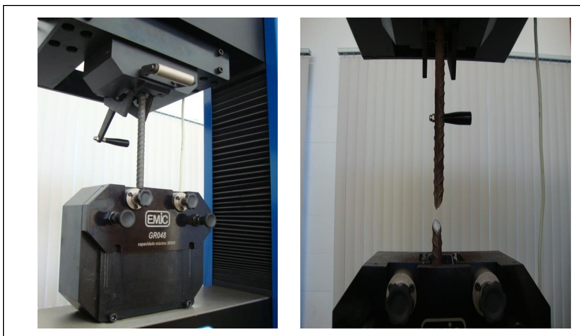
Ilustração 9 – Ensaio de Tração em uma barra de aço
