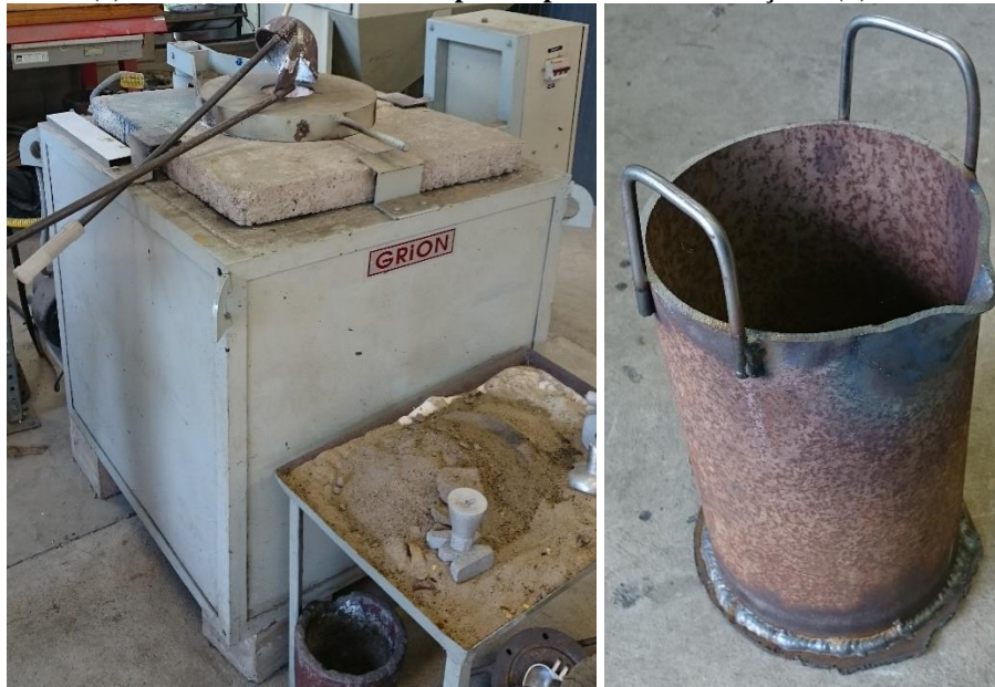
Figura 10 - (a) forno industrial utilizado para o processo de fundição e (b) cadinho de aço.
