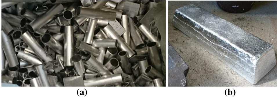
Figura 20 - (a) alumínio oriundo da indústria e (b) lingote produzido.
