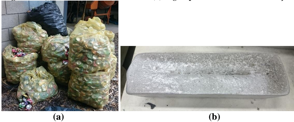
Figura 21 - (a) volume de latas amassadas e (b) lingote produzido através da fundição.
