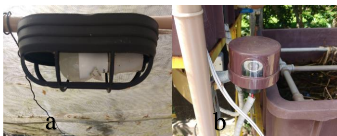
Figura 7 - Sistema de iluminação artificial. a) Lâmpada LED 600 lumêns. b) Fototransistor.
