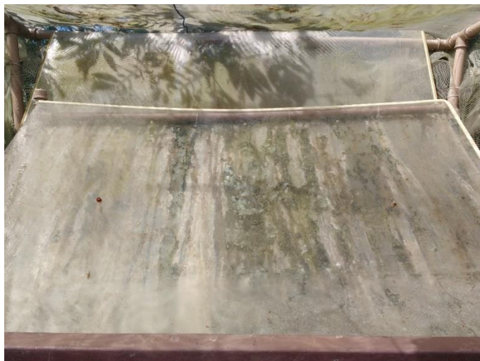
Figura 6 - Visão frontal do duplo acrílico. Acrílico interno para adesão do biofilme e acrílico externo para proteção contra eventos climáticos.
