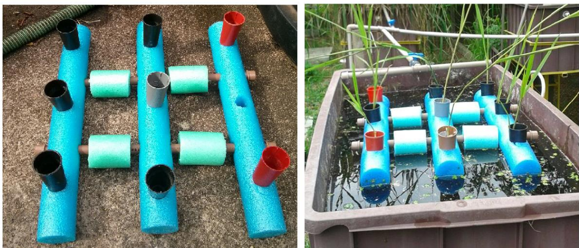
Figura 20 -Registros da fabricação do sistema suporte flutuante para o W1 e o mesmo após a adição das macrófitas.
