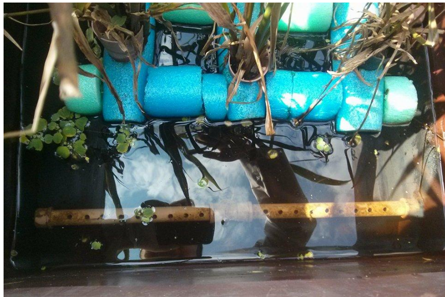
Figura 21 - Sistema de drenagem implementado no W1.
