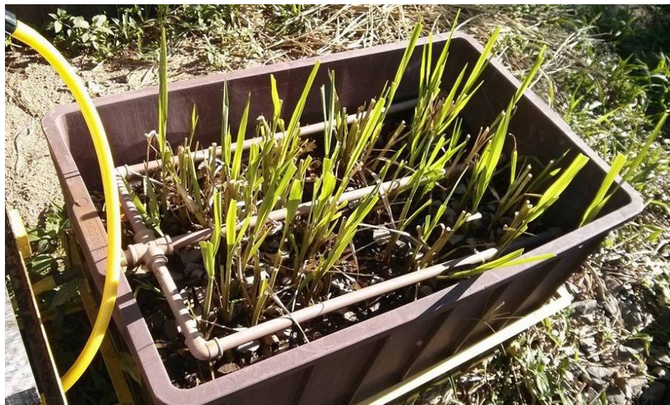
Figura 12 - Wetland Construído de Fluxo Superficial Vertical (W3).
