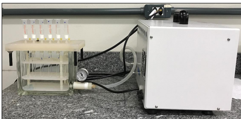
Figura 9 – Sistema manifold acoplado a bomba de vácuo.
