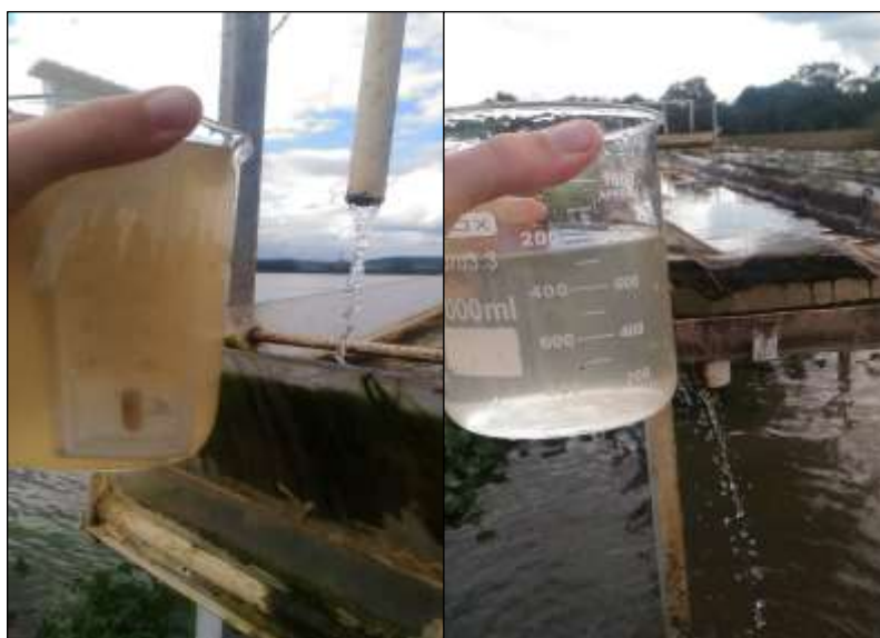
Figura 7 - Diferença de turbidez entre a água bruta (que entra no sistema) e a água tratada (na saída do sistema).
