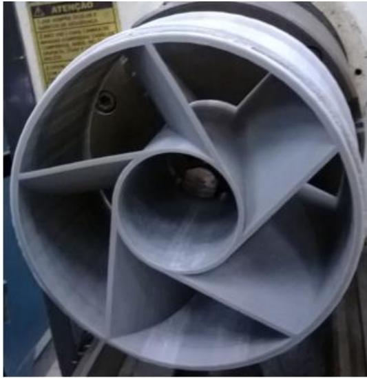
Figura 22 - Turbina Fabricada em impressora 3-D
