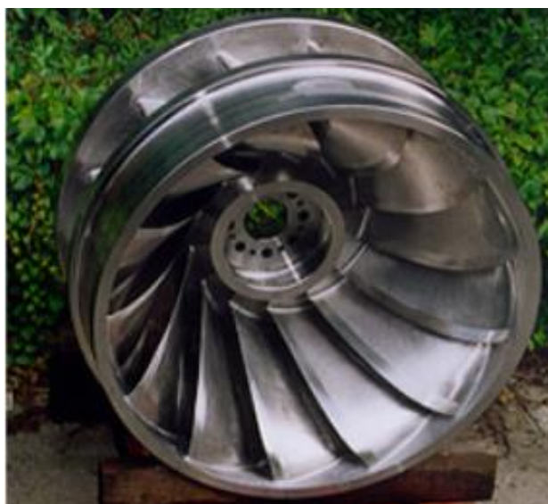
Figura 8 - Rotor turbina do tipo Francis
