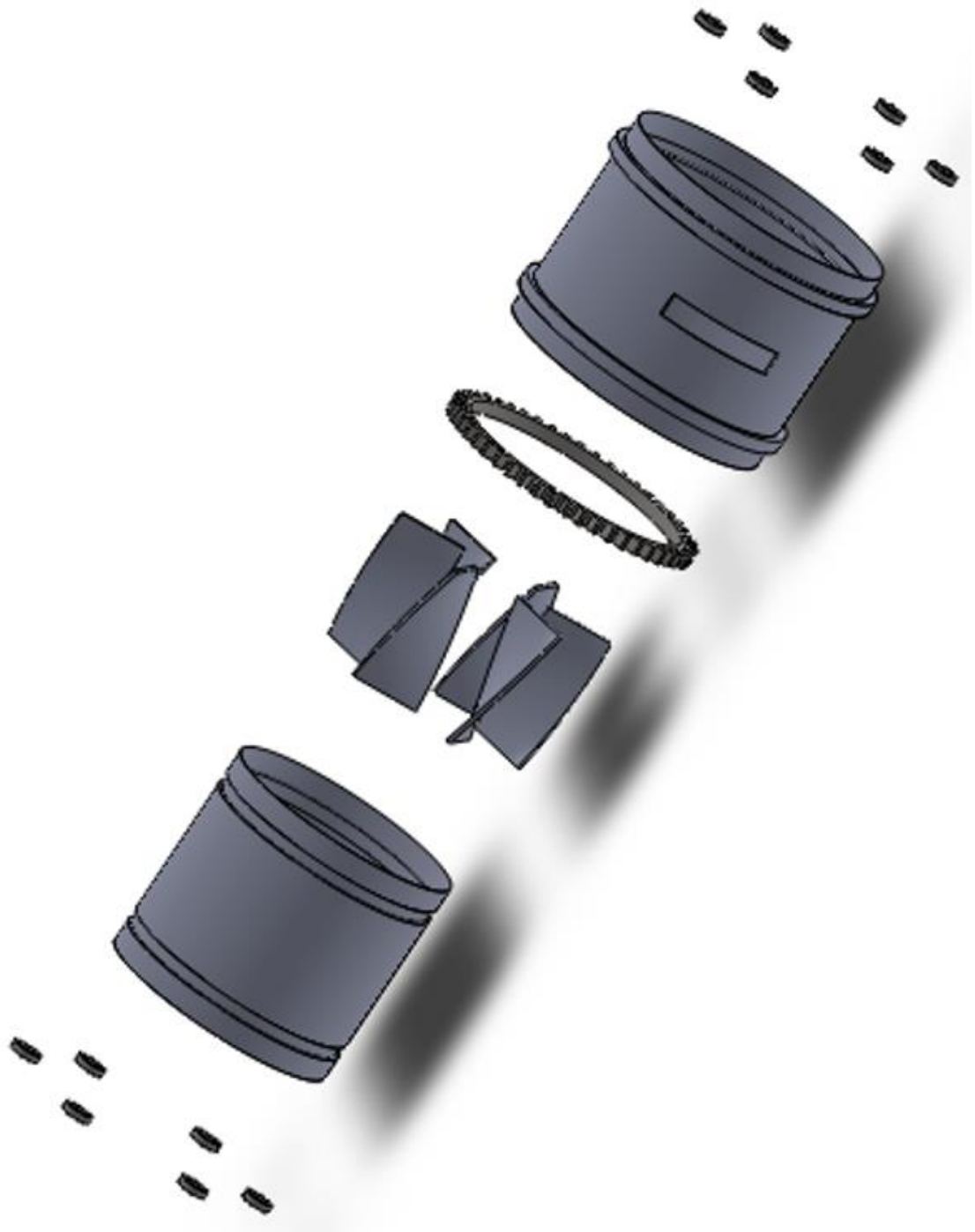
Figura 20 - Vista explodida da turbina projetada
