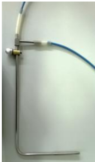
Figura 25 - Tubo de Pitot utilizado para medir a variação de pressão no sistema
