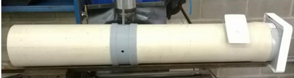
Figura 24 - Tubulação, exaustor e tubo de pitot posicionados para ensaio
