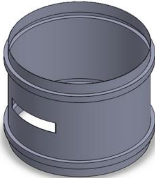
Figura 15 - Perspectiva isométrica da estrutura externa da turbina projetada
