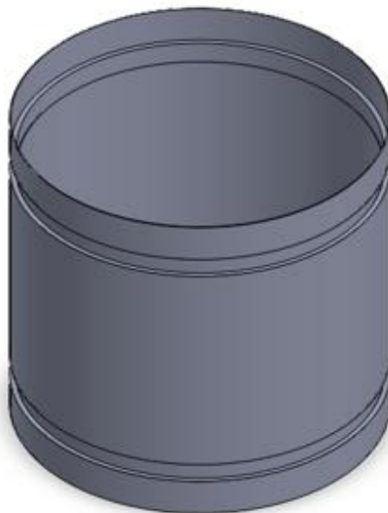
Figura 16 - Perspectiva isométrica da carcaça do rotor da turbina
