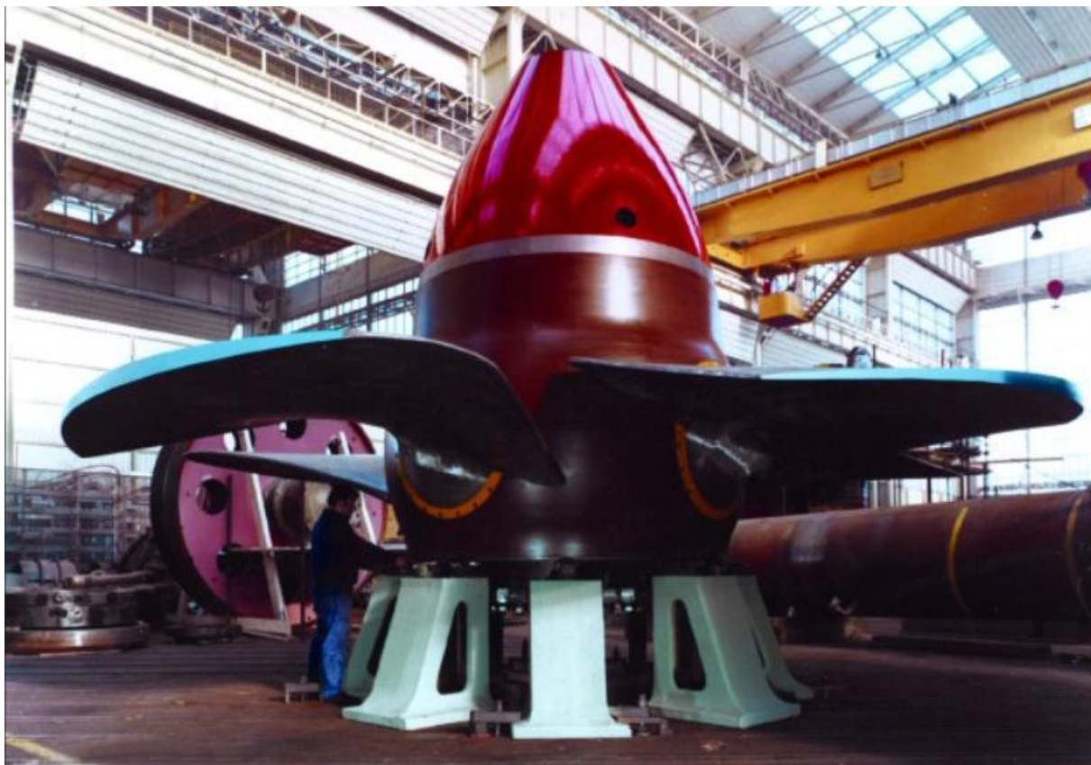
Figura 95 - Rotor de turbina do tipo Kaplan
