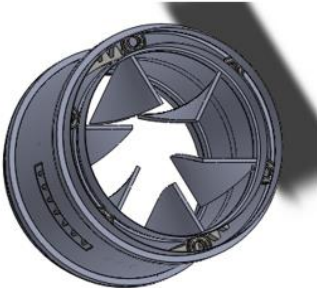
Figura 14 - Perspectiva isométrica do protótipo da turbina projetada
