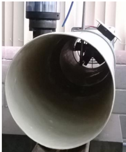
Figura 23 - Tubulação e exaustor posicionados para ensaio
