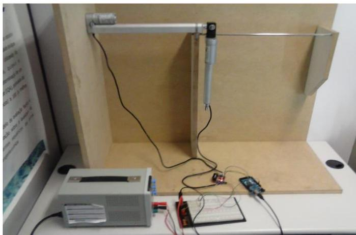
**Figura 22.** Montagem para a realização do teste do programa para a automação do processo.
