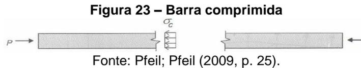
Identifica-se como coluna, uma peça vertical submetida à compressão centrada. O esforço de compressão evidencia o efeito de curvatura na peça, e os deslocamentos laterais gerados passam a compor a flambagem por flexão, que em geral, diminui a capacidade de carga do elemento comparado ao que ocorre na peça tracionada (PFEIL; PFEIL, 2009).
