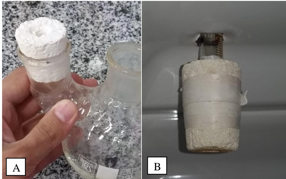
Figura 10 - Conexões feitas com tijolo refratário
