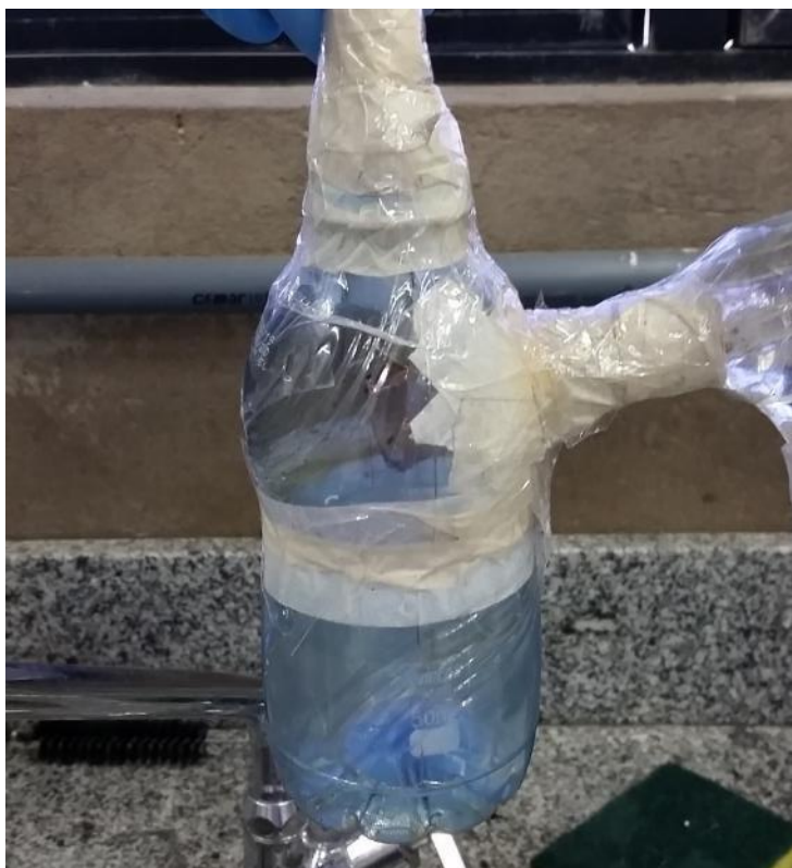
Figura 18 - Sistema de coleta de condensado
