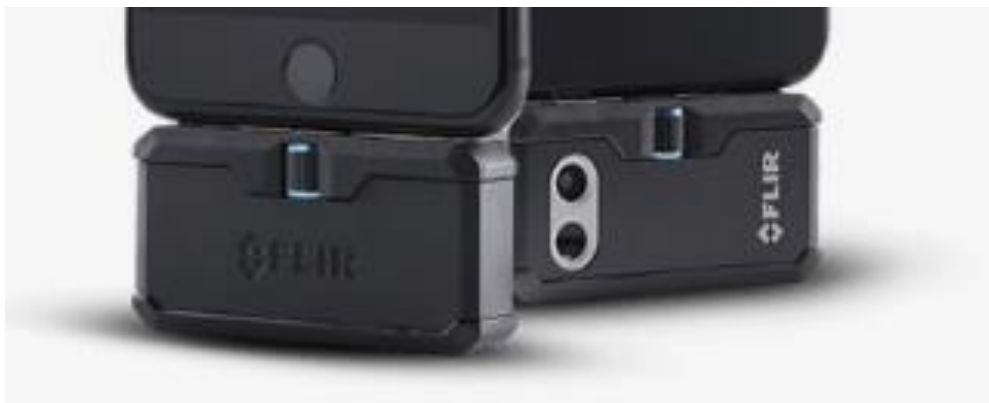
Figura 8 - Câmera FlirOne acoplada em smartphone
