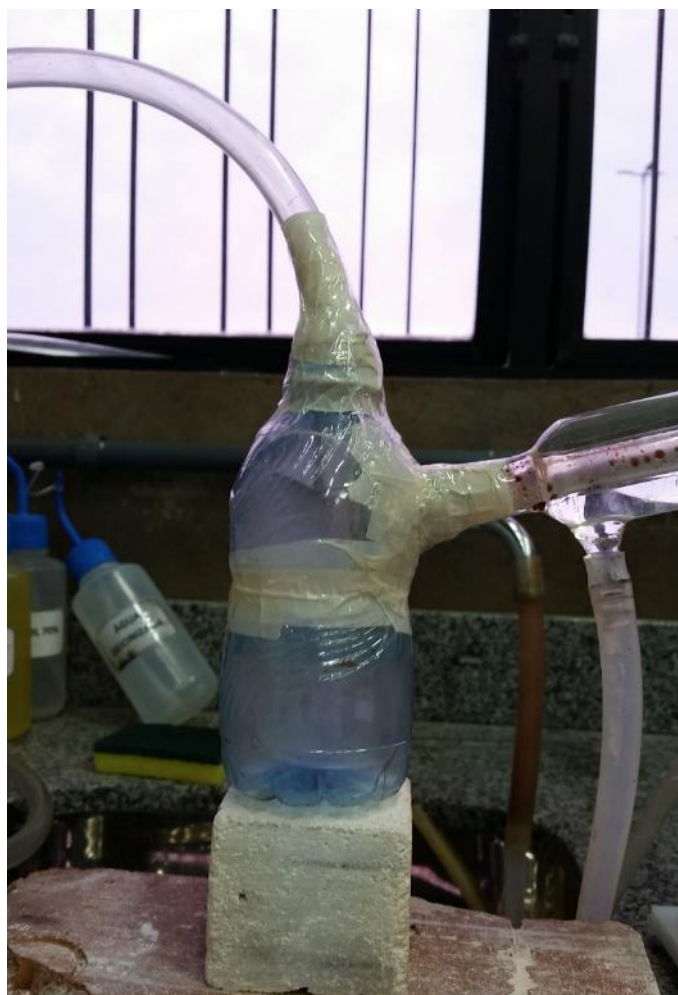
Figura 12 - Sistema de confinamento e exaustão dos gases
