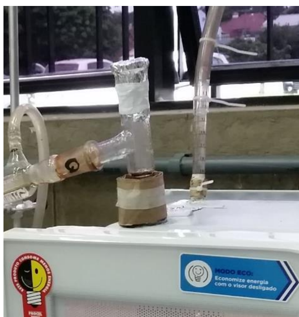
Figura 23 - Tubulações acopladas no forno
