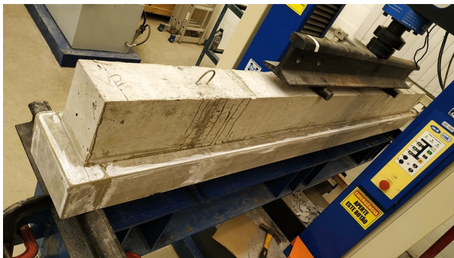
Figura 47 – Viga testemunho reforçada posicionada para ensaio.
