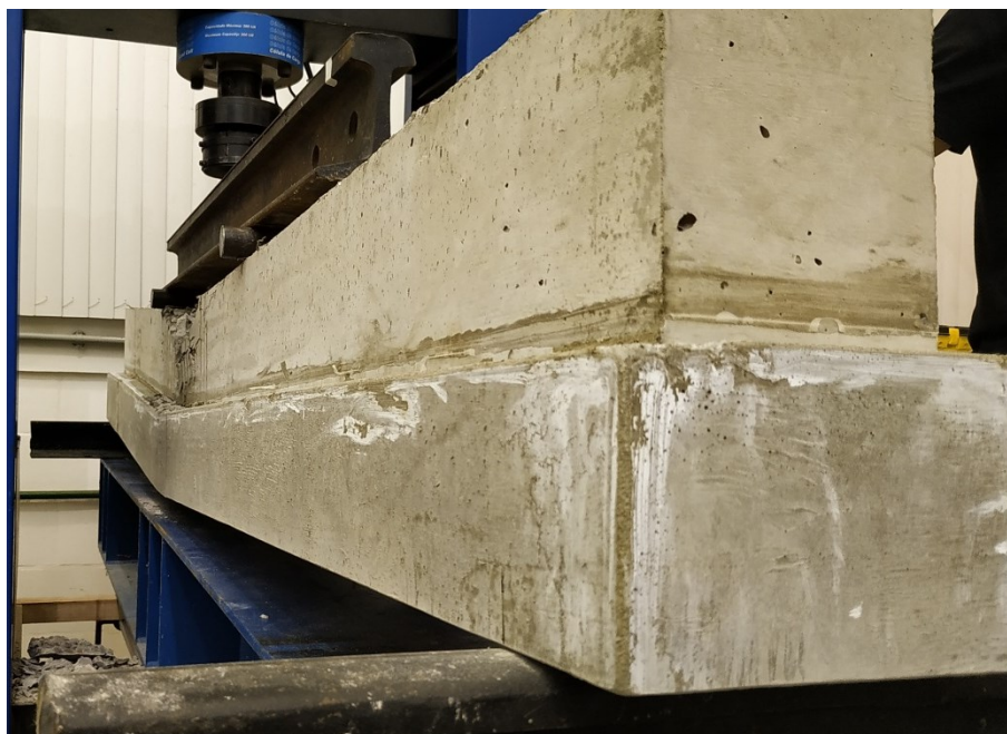
Figura 56 – Rompimento viga 3 reforçada.
