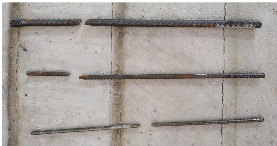
Figura 42 – Aço ensaiado para obtenção do f_y real.
