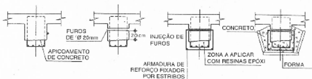
Figura 9 – Reforço de viga com nova armadura atada à mesma.
