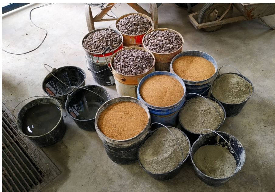
Figura 27 – Materiais componentes do concreto.
