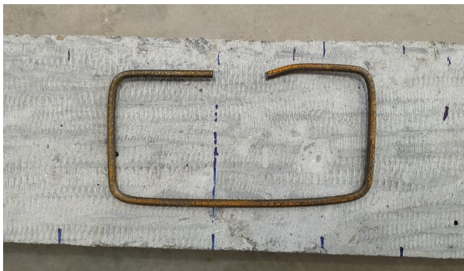
Figura 32 – Estribos 5 mm de reforço das vigas.
