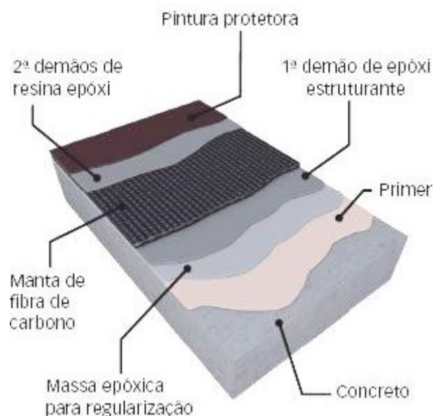
Figura 6 – Camadas constituintes para aplicação da fibra de carbono.
