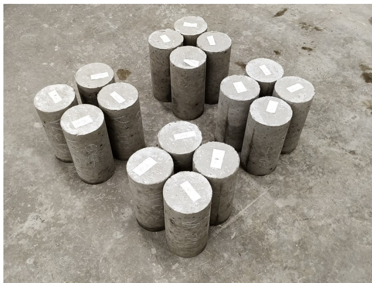
Figura 28 – CP's do concreto desmoldados.
