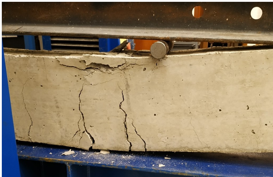
Figura 51 – Detalhe viga 4 testemunho rompida.
