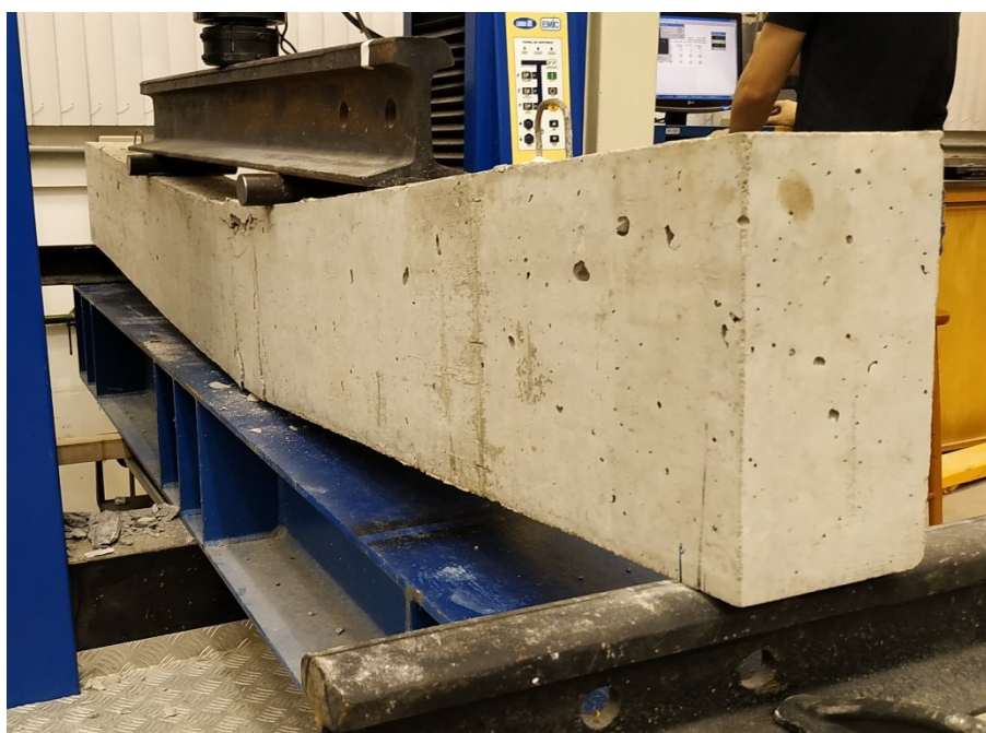
Figura 50 – Viga 4 testemunho rompida.
