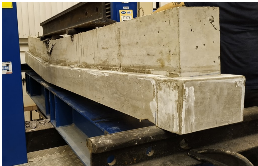
Figura 54 – Rompimento viga 2 reforçada.
