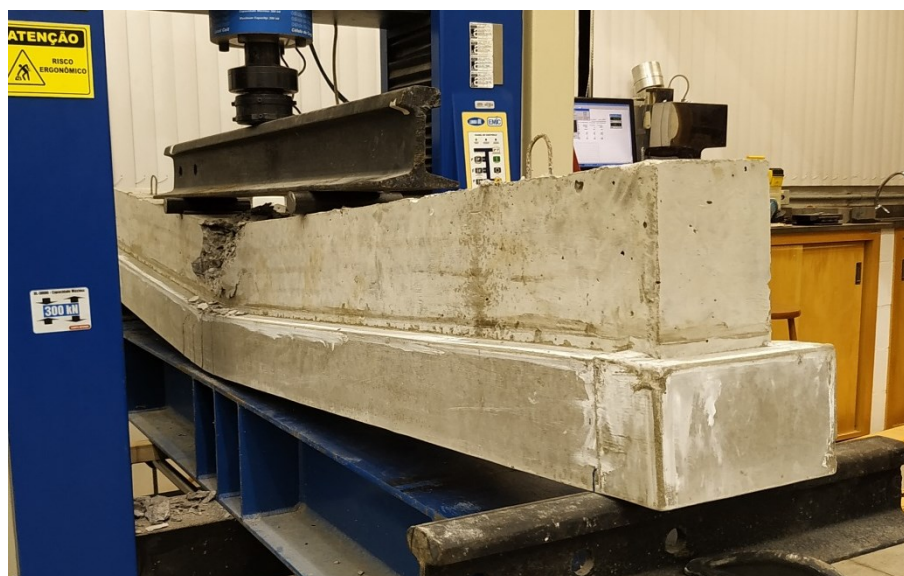
Figura 52 – Rompimento viga 1 reforçada.
