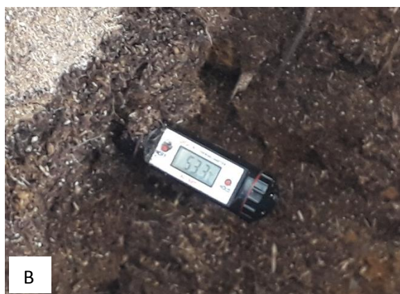
Figura 10 – Monitoramentos diários. Em A – abertura da cava e inserção do termômetro digital, em B – visor termômetro digital, em C – revolvimento do tratamento, em D – planilha de controle.
