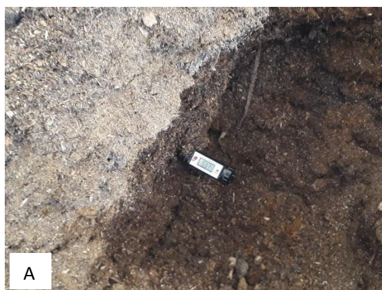
Figura 10 – Monitoramentos diários. Em A – abertura da cava e inserção do termômetro digital, em B – visor termômetro digital, em C – revolvimento do tratamento, em D – planilha de controle.
