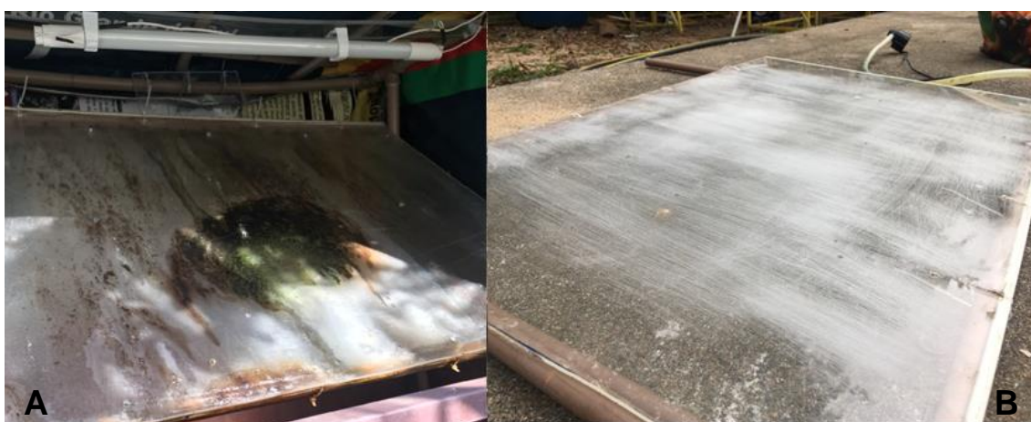
Figura 10 – Suporte de acrílico para a fixação das microalgas. Na figura A é possível observar o biofilme formado por microalgas e na figura B observam-se as rugosidades para facilitar a adesão das mesmas.
