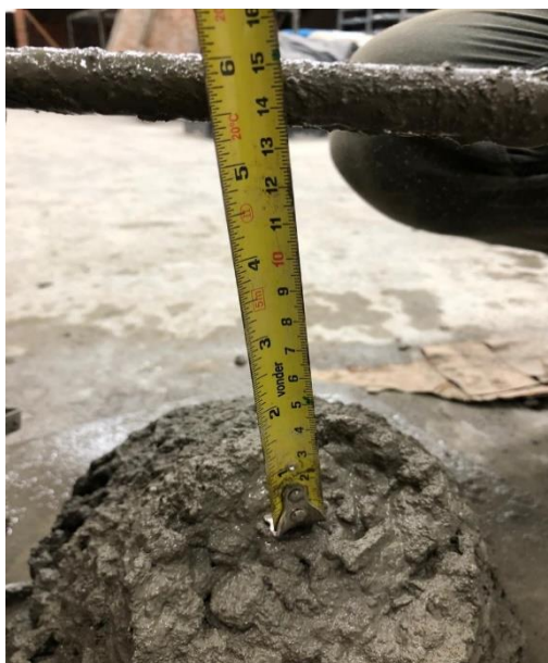
Figura 32 - Ensaio de abatimento de tronco de cone ou 'Slump'.
