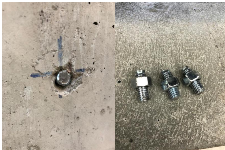
Figura 45 - Ruptura da seção transversal do chumbador por cisalhamento.
