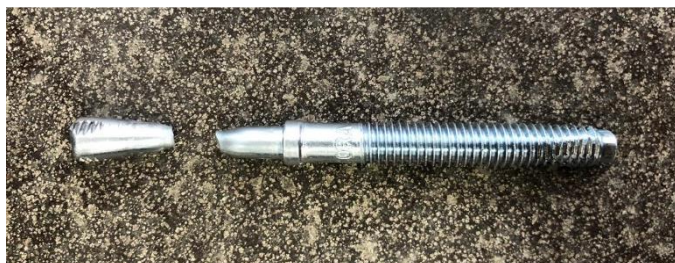
Figura 44 - Ruptura do chumbador por tração.
