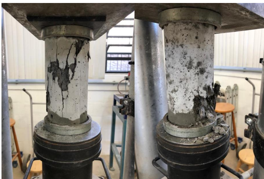
Figura 43 - Corpos de prova rompidos através do ensaio de compressão.
