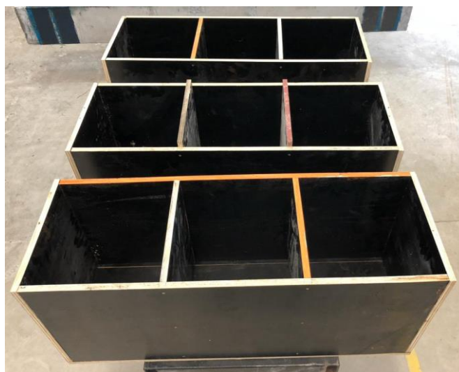
Figura 29 - Formas para moldagem dos blocos.
