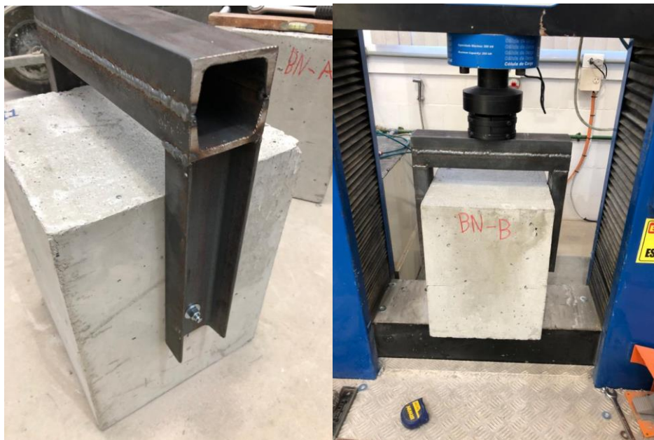
Figura 42 - A esquerda mostra o dispositivo de suporte fixado ao bloco de concreto, e a direita, o ensaio sendo realizado.
