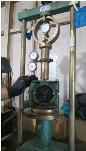
**b) corpo de prova rompido após o ensaio**
