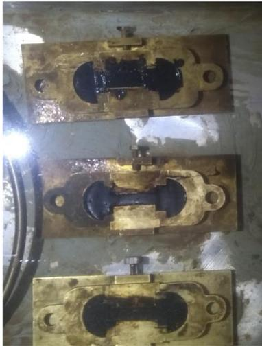
**b) corpo de prova tracionado (L1)**
