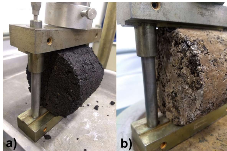
Figura 9 – Corpos de prova ensaiados à resistência à tração por compressão diametral: a) Mistura com fresado b) Mistura com pó de brita
