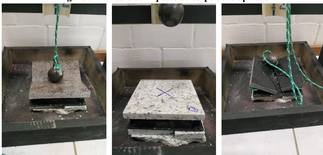
Figura 67 - Ensaio de impacto de corpo duro apoiado
