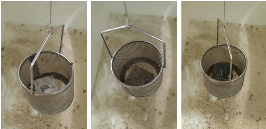
Figura 60 - Processo de pesagem submersa dos corpos de prova através da balança hidrostática
