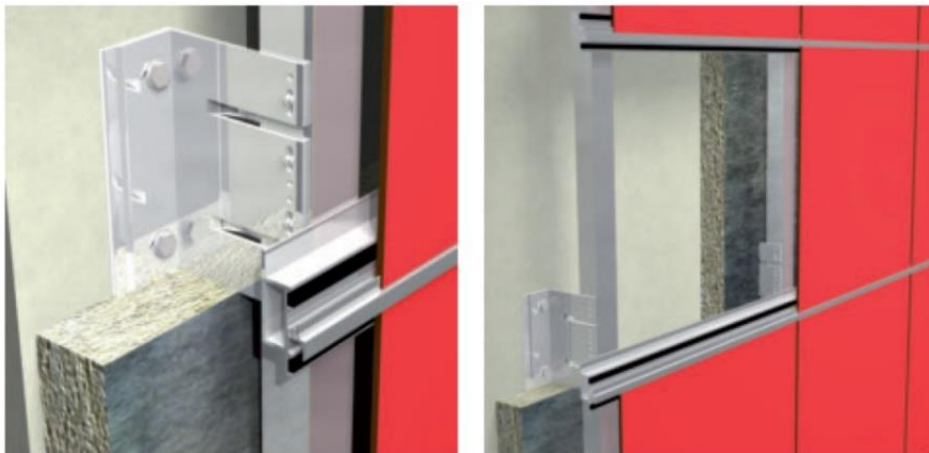
Figura 54 - Fixação linear e revestimento com ranhuras contínuas nos bordos
