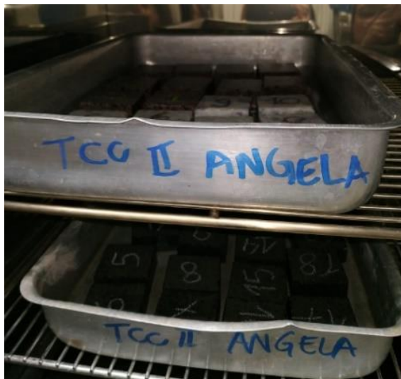
Figura 62 - Secagem dos corpos de prova em estufa
