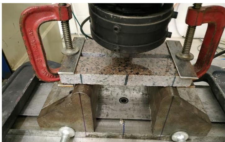
Figura 74 - Amostra do conjunto ancoragem e granito marrom São Gabriel ensaiada a flexão
