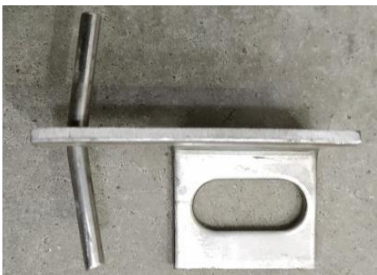
Figura 102 - Insert metálico após a aplicação de carga
