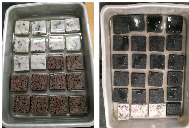
Figura 58 - Corpos de prova submersos até 1/3 da sua altura
