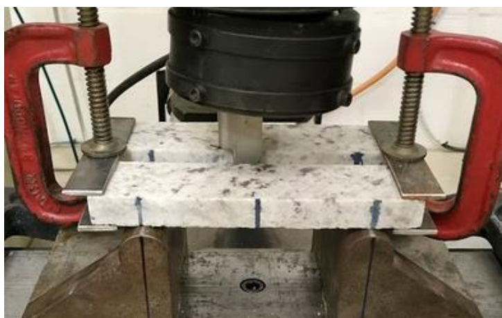
Figura 73 - Amostra do conjunto ancoragem e granito branco Itaúnas ensaiada a flexão
