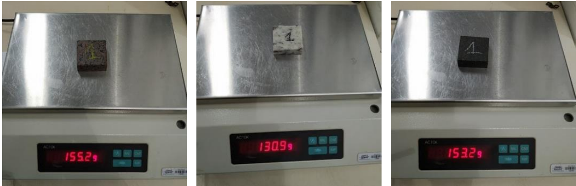
Figura 61- Pesagem dos corpos de prova saturados
