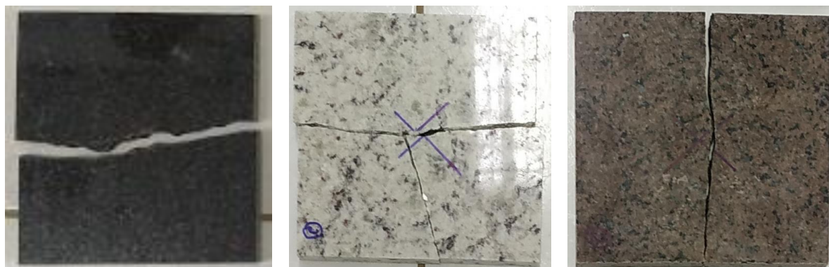
Figura 98 - Padrões de ruptura representativos no ensaio de impacto de corpo duro apoiado
