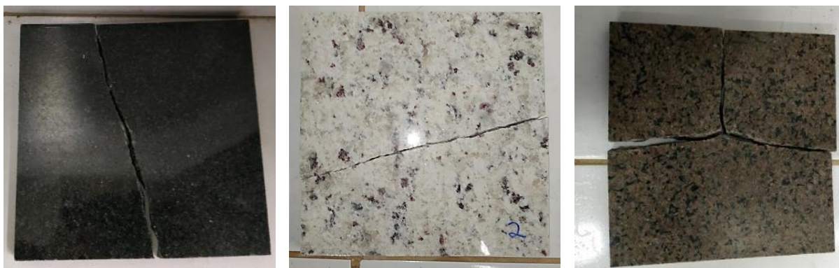
Figura 97 - Padrões representativos de ruptura verificados no ensaio de impacto de corpo duro
