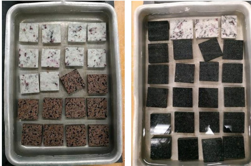
Figura 59 - Corpos de prova com a submersão completa
