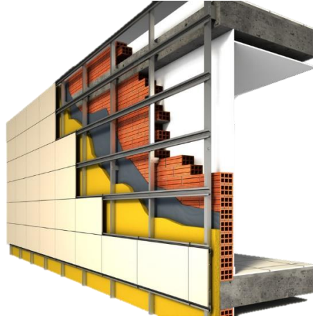
Figura 38 -Placas fixadas em subestrutura metálica ancorada da estrutura da edificação
