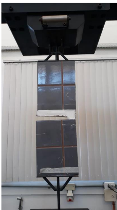
Figura 16 - Ruptura do selante
