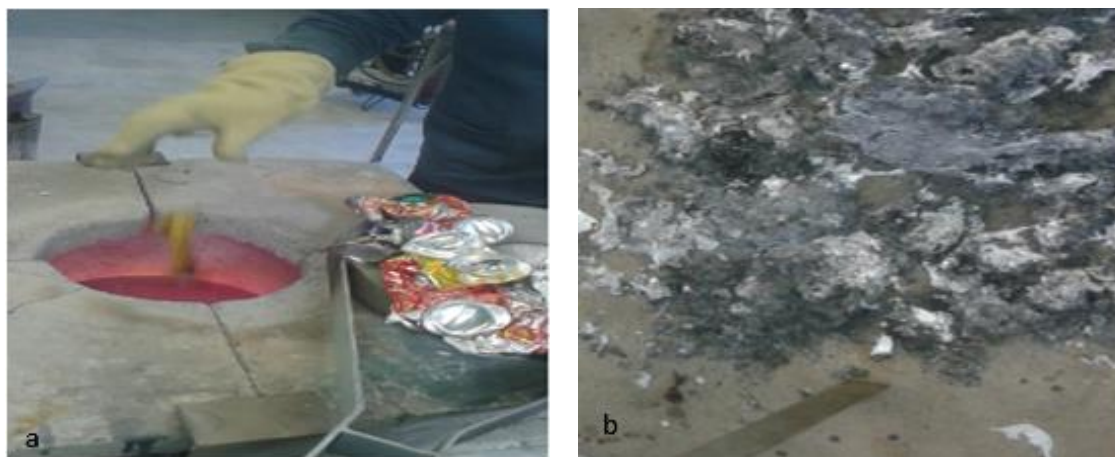
Figura 3: Processo de fundição de latas de alumínio. a) Colocação manual das latas de alumínio. b) Escória retirada do fundido.
