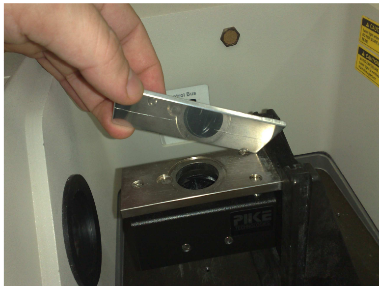
Figura 11 – Posicionamento da chapa sobre o acessório de reflexão especular PIKE
