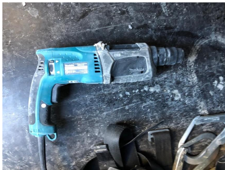
Figura 29 - Furadeira utilizada para realização dos furos
