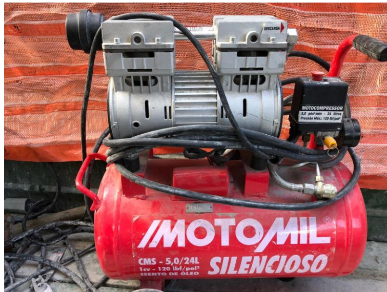
Figura 32 – Protótipos A e B - Compressor utilizado para limpeza dos furos
