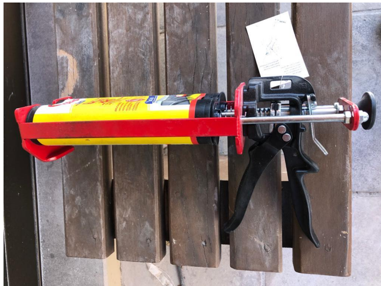
Figura 42 - Protótipo B - Resina epóxi com aplicador e bico misturador
