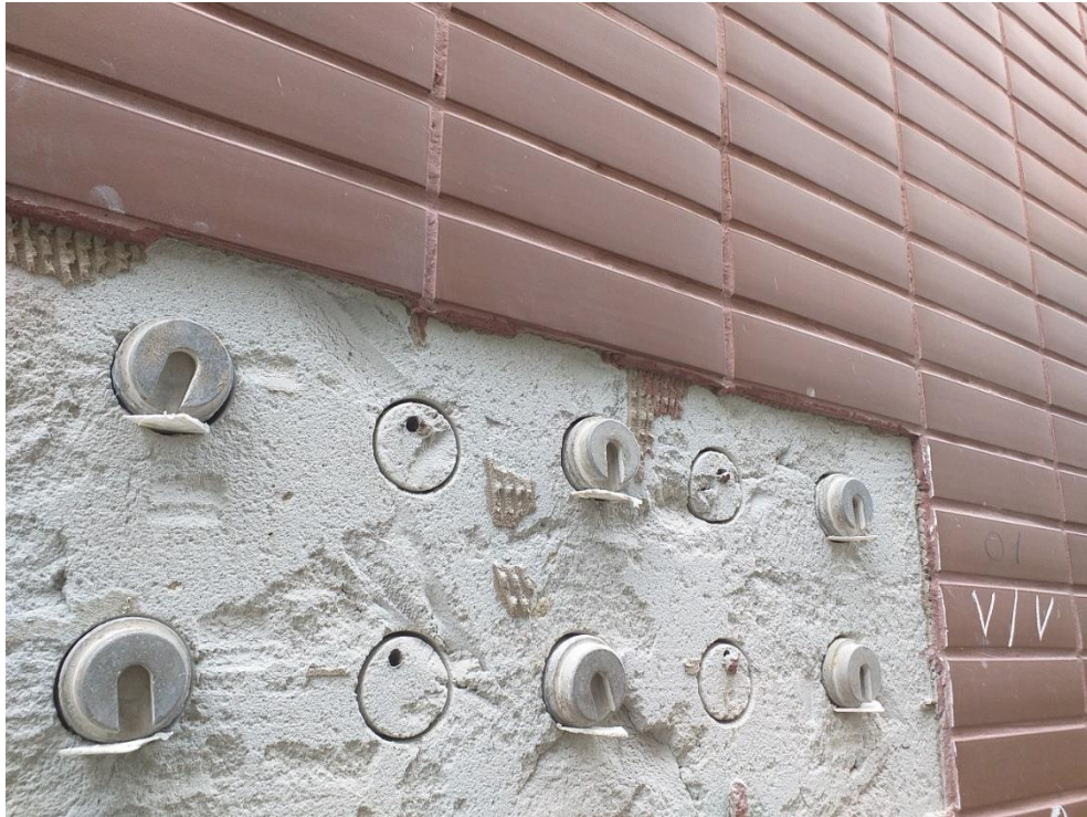
Figura 80 - Protótipos E e F - Teste de aderência à tração
