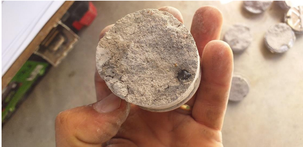
Figura 74 - Ensaio de arrancamento protótipo C - Corpo de prova
