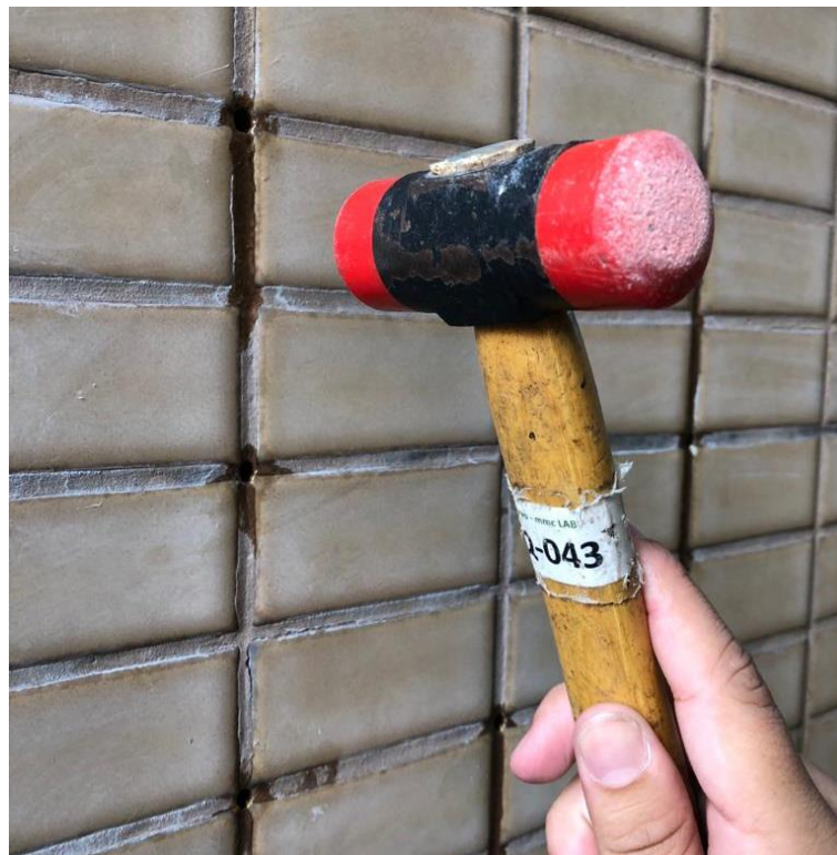
Figura 65 - Protótipos A - Ensaio de percussão após as injeções de resina epóxi
