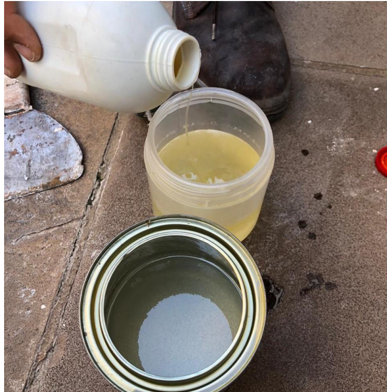
Figura 39 - Protótipo A - Mistura da resina epóxi bicomponente Marca A
