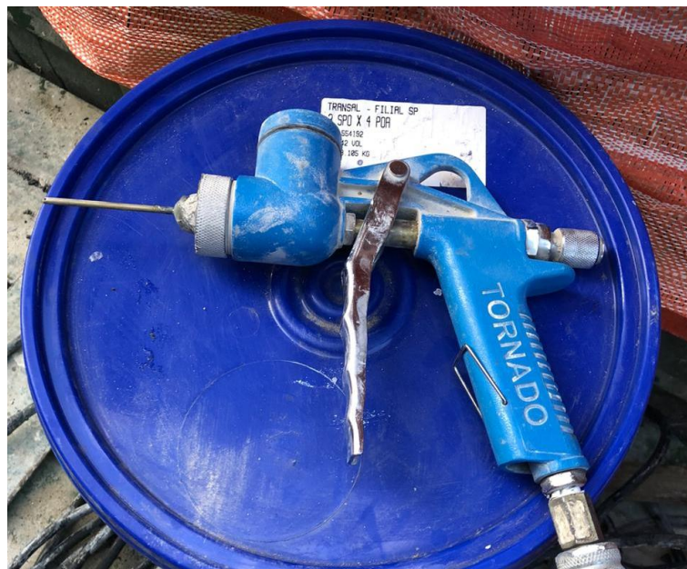
Figura 33 – Protótipos A e B - Pistola com agulha acoplada para limpeza dos furos
