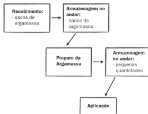
Figura 6 - Fluxograma para argamassa industrializada
