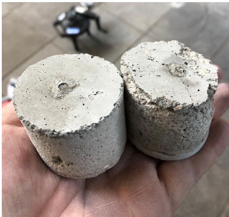
Figura 68 - Ensaio de arrancamento protótipo A - Corpo de prova
