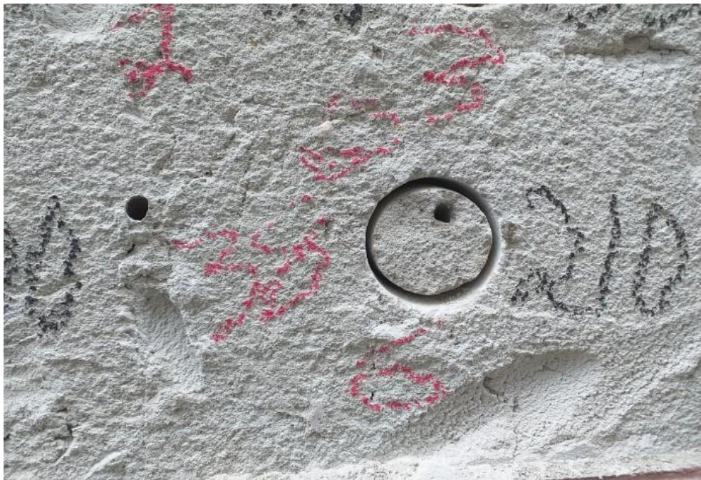
Figura 84 - Ensaio de arrancamento protótipo F - Ruptura na interface argamassa/cola
