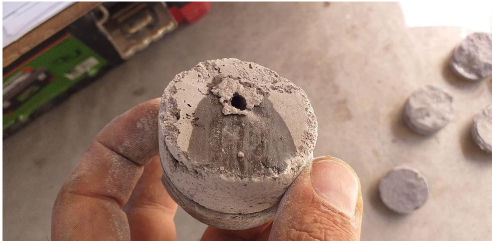
Figura 78 - Ensaio de arrancamento protótipo D - Corpo de prova
