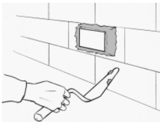
Figura 12 - Execução de talisca
