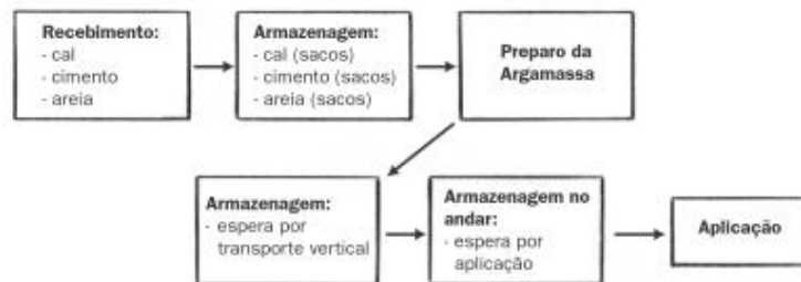
Figura 7 - Fluxograma para argamassa produzida em obra
