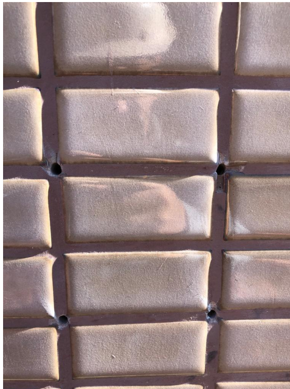
Figura 31 - Protótipos A e B - Furos 5mm de diâmetro
