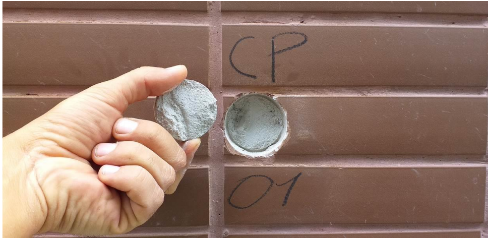
Figura 58 - Corpo de prova – Descolamento entre chapadas
