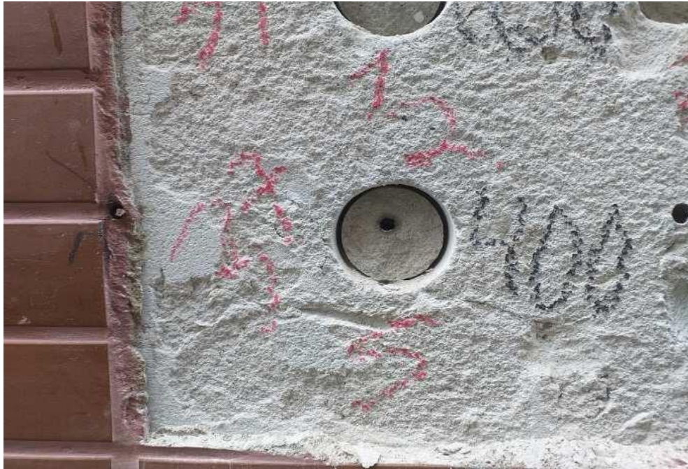
Figura 83 - Ensaio de arrancamento protótipo F – Ruptura no interior da argamassa
