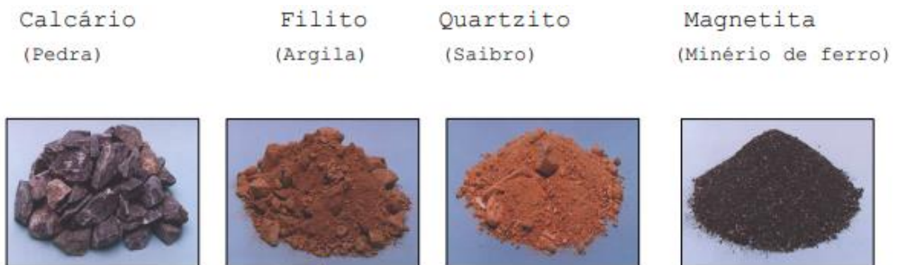
Figura 2: Matérias primas básicas para a fabricação do cimento Portland
