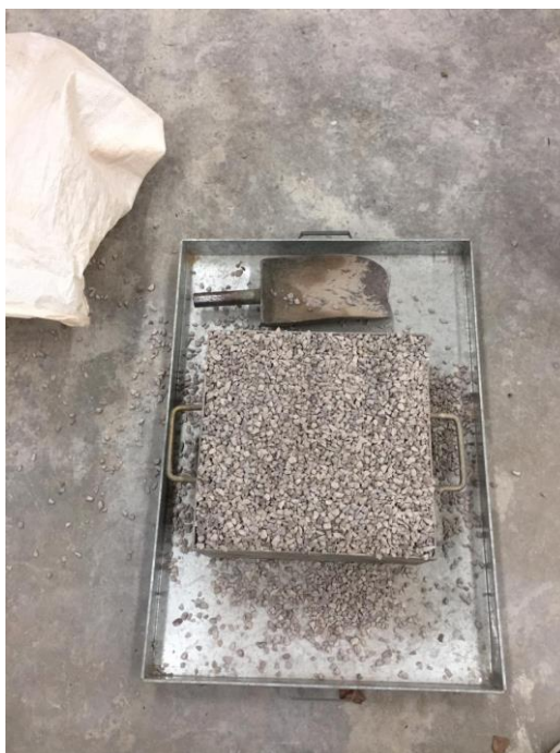
Figura 25: Enchimento do recipiente com agregado.
