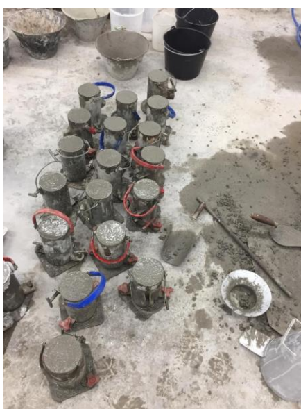
Figura 30: Moldagem corpo de provas.
