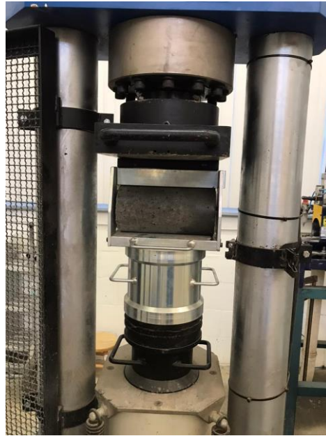
Figura 32: Ensaio de Resistência à Tração por Compressão Diametral.
