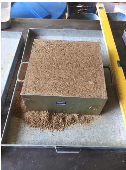
Figura 26: Nivelamento da camada superficial do recipiente.
