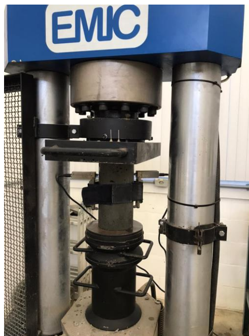
Figura 33: Ensaio de Determinação do Módulo de Elasticidade.
