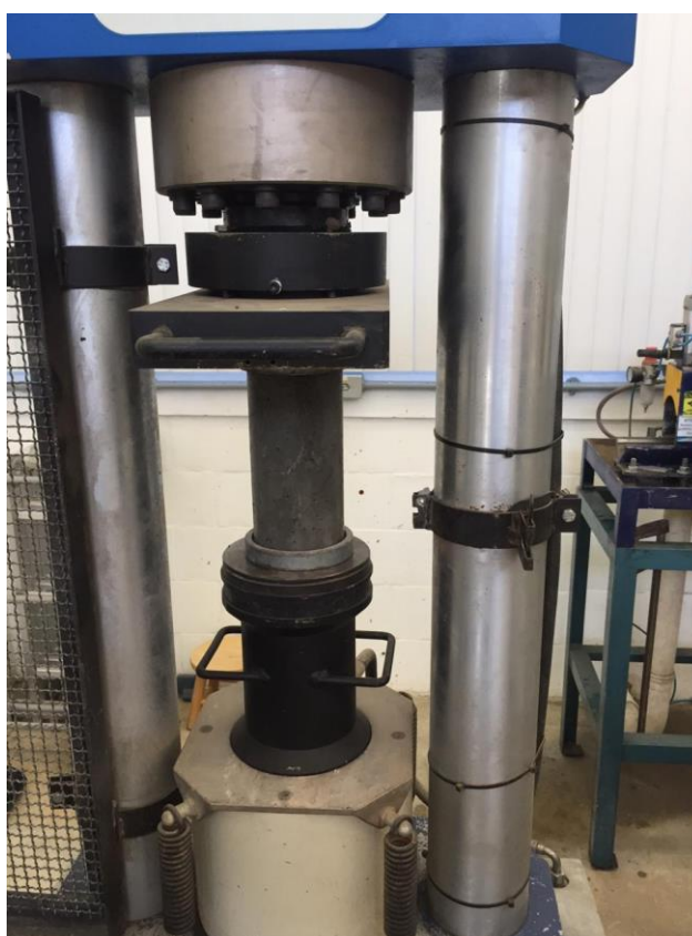
Figura 31: Rompimento por Compressão Axial do corpo de prova
