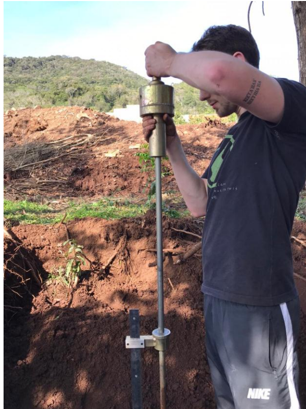
Figura 19 - Equipamento DCP utilizado
