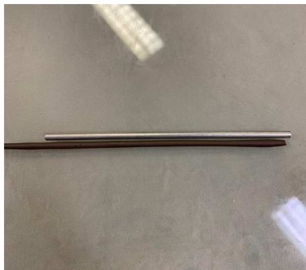
Figura 24 - Ensaio do limite de plasticidade (LP)
