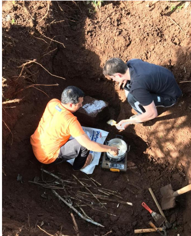
Figura 18 - Aplicação da parafina no bloco
