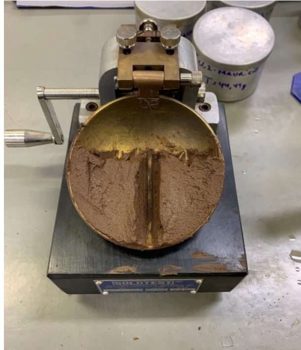
Figura 23 – Ensaio do limite de liquidez (LL)
