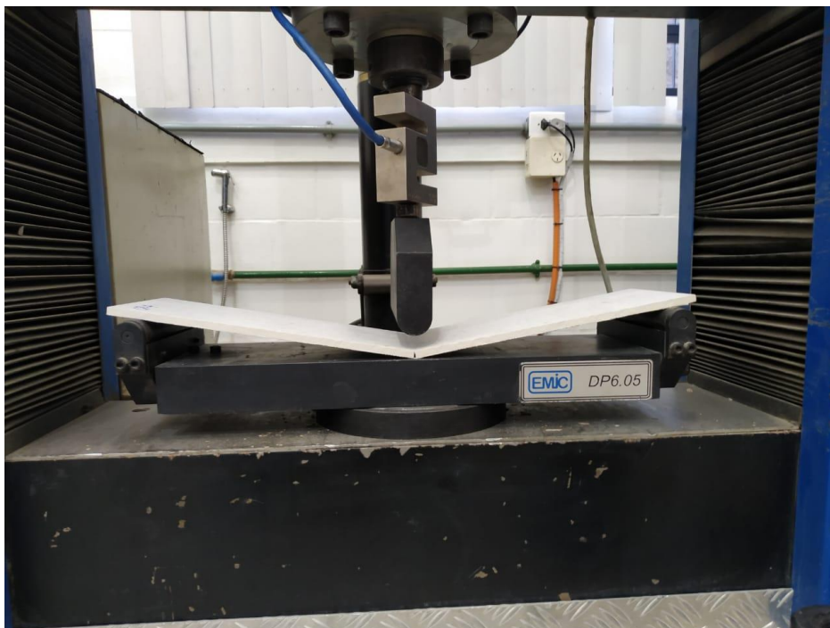
Figura 60 – Ruptura da placa de porcelanato
