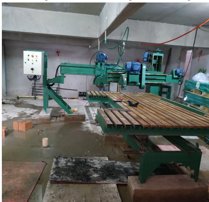
Figura 92 – Máquina automatizada para corte de porcelanato
