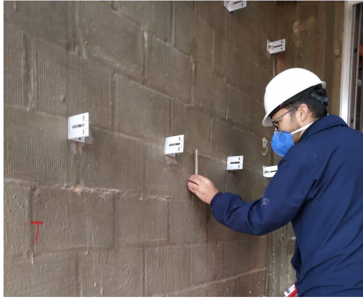
Figura 63 – Aplicação do método do cachimbo no produto Viaplus 7000
