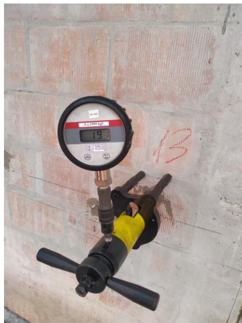
Figura 54 – Equipamento utilizado para o ensaio de arrancamento
