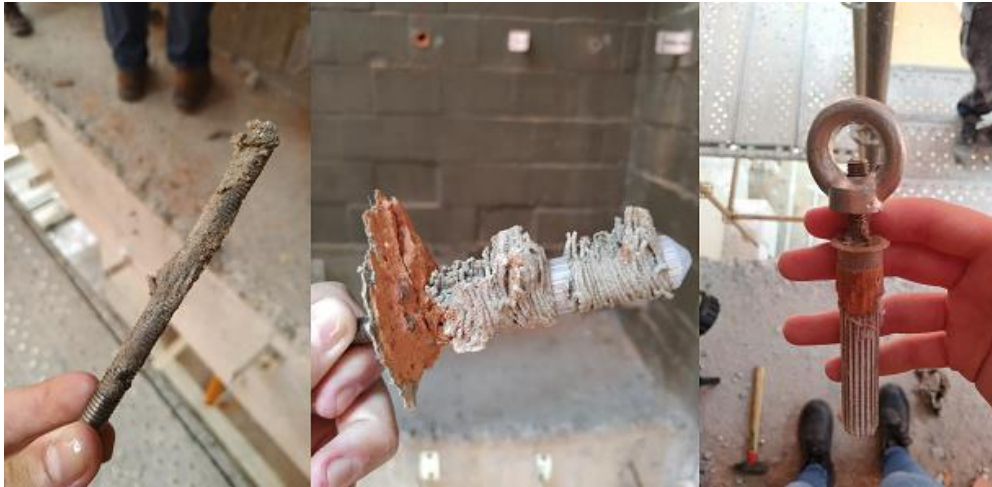
Figura 69 – Chumbador químico após o teste de arrancamento
