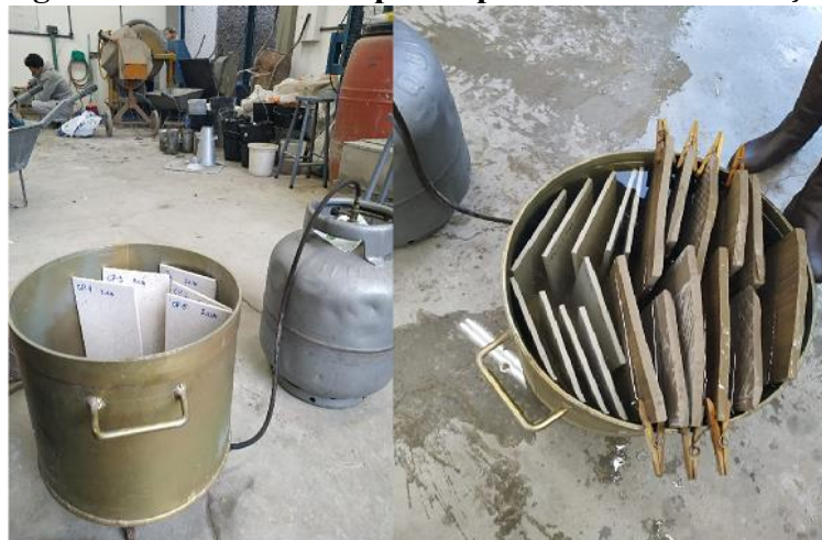
Figura 45 – Imersão das placas para ensaio de absorção
