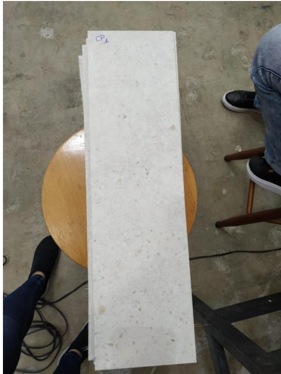
Figura 42 – Corpo-de-prova para ensaio de absorção de água
