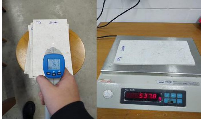
Figura 44 – Determinação da massa ( m_1 ) após resfriamento das placas
