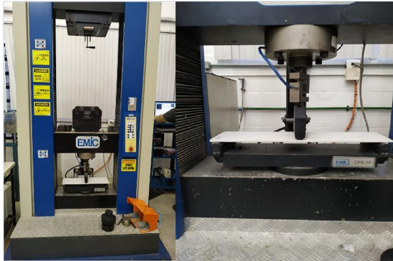
Figura 48 – Dispositivo para obtenção da carga de ruptura e módulo de resistência a flexão em três pontos da placa de porcelanato
