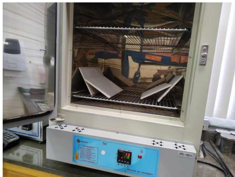
Figura 43 – Secagem dos corpos-de-prova em estufa ( 110 \pm 5 °C)
