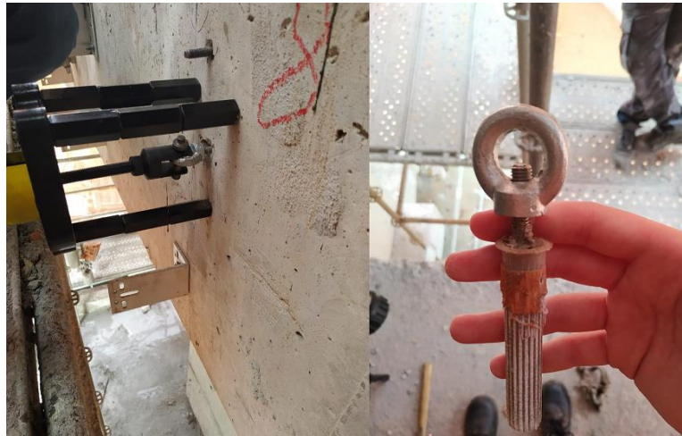
Figura 53 – Chumbador com olhal utilizado no ensaio
