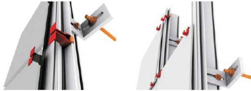
Figura 24 – Fixação por grampos com e sem sobreposição
