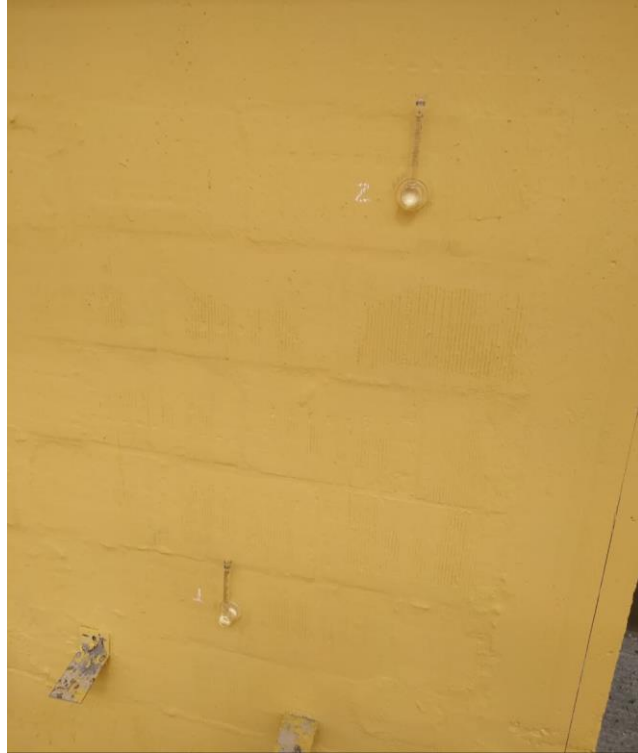
Figura 62 – Aplicação do método do cachimbo no produto Sto Gold Coat 80265
