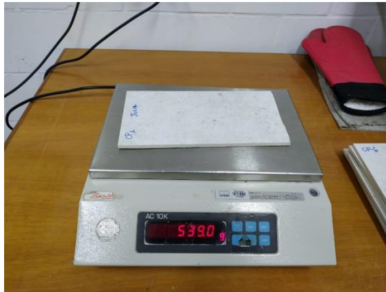
Figura 46 – Determinação da massa ( m_2 ) com as placas saturadas
