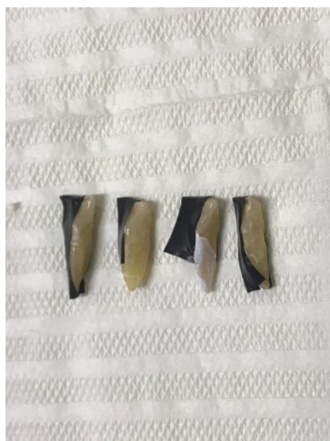
Figura 5 – Proteção do lado não tratado com fita teflon e isolante
