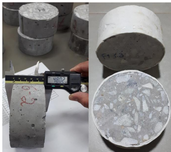
Figura 25 - Medição e selagem das amostras de concreto
