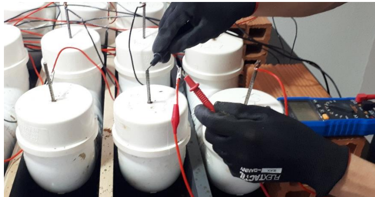
Figura 28 - Medição da corrente elétrica que atravessa o aparato de migração
