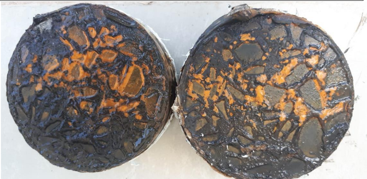
Face após limpeza dos produtos da corrosão
