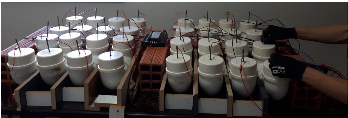
Figura 26 - Medição da tensão nos aparatos de migração de cloretos
