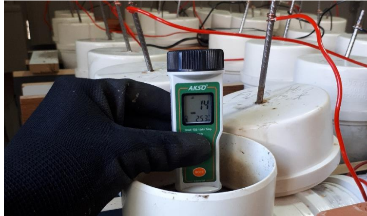
Figura 27 - Medição da condutividade na célula anódica
