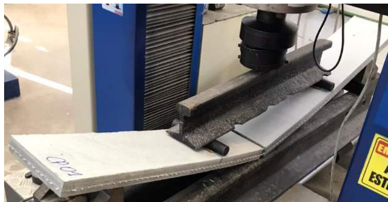
Figura 34 – Estádio III, ruptura da placa 01.
