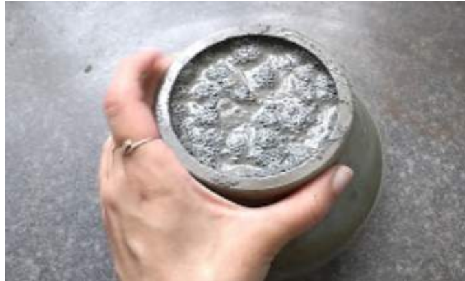
Figura 20 – Etapas do ensaio de espalhamento: (a) molde preenchido; (b) medição do primeiro diâmetro; (c) medição do segundo diâmetro
