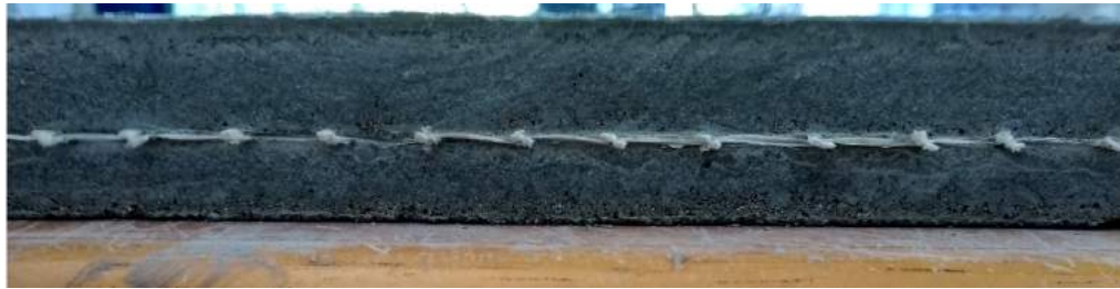
Figura 27 – Aspecto lateral do compósito, após desforma
