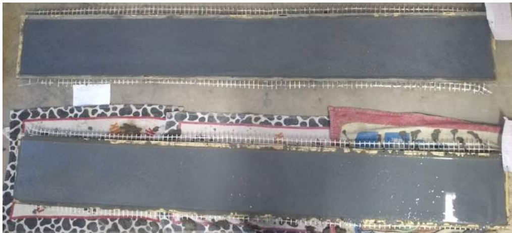
Figura 25 – Aspecto final do compósito, após concretagem
