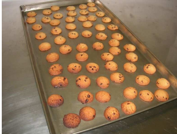
Figura 19 - Bandeja apresentando biscoitos com diferentes cores e com bordas queimadas.
