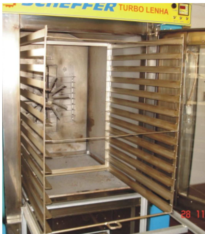
Figura 22 - Carro modificado com 13 andares. Fonte: Registro fotográfico do autor, 2005.
