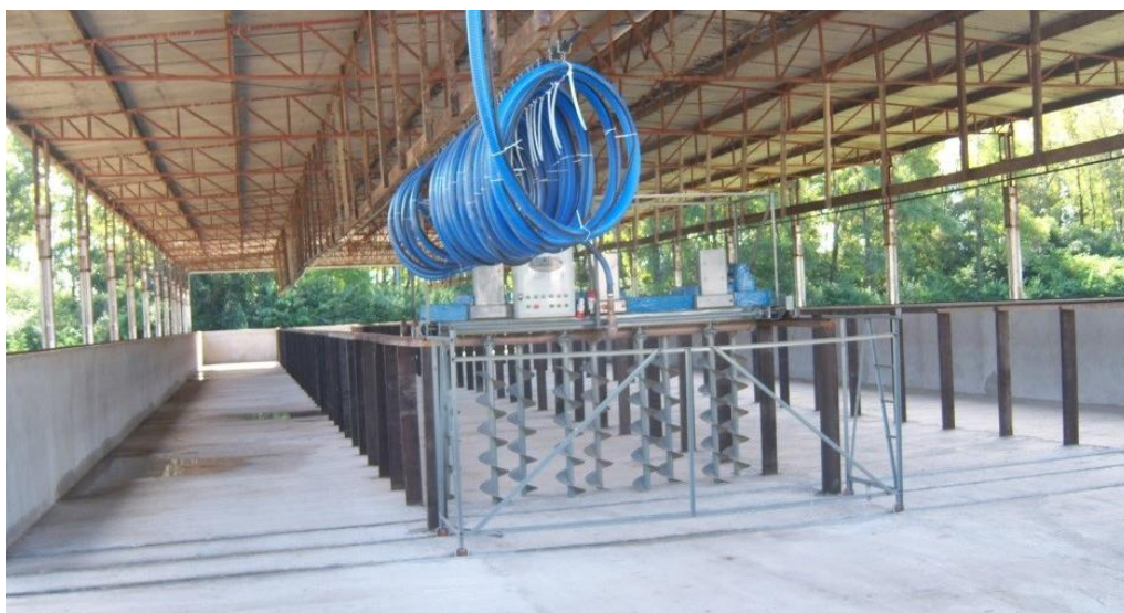
Figura 4. Confeção do equipamento destacando as pás helicoides e as quatro leiras a serem utilizadas nos processos de compostagem.
