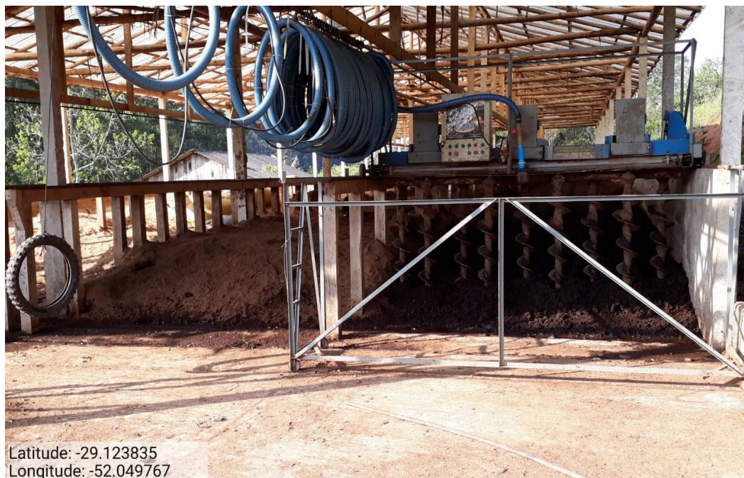
Figura 12. Vista geral das leiras e das instalações com sistema de helicoides.
