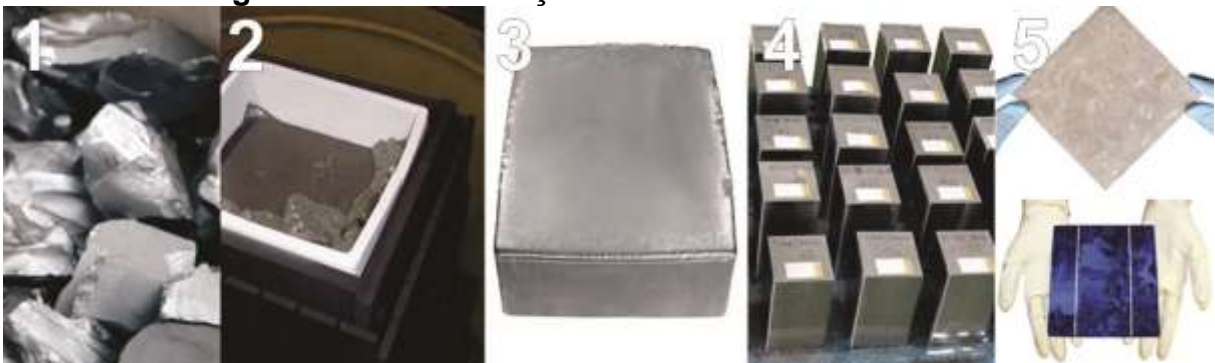
Figura 9 - Transformação do silício em uma célula FV
