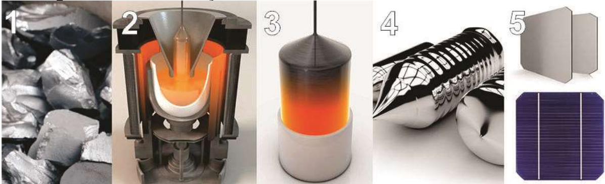
Figura 8 - Transformação do silício em uma célula FV monocristalina.
