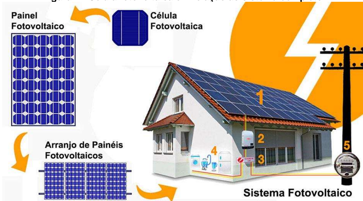
Figura 7 - Célula fotovoltaica em relação ao sistema completo
