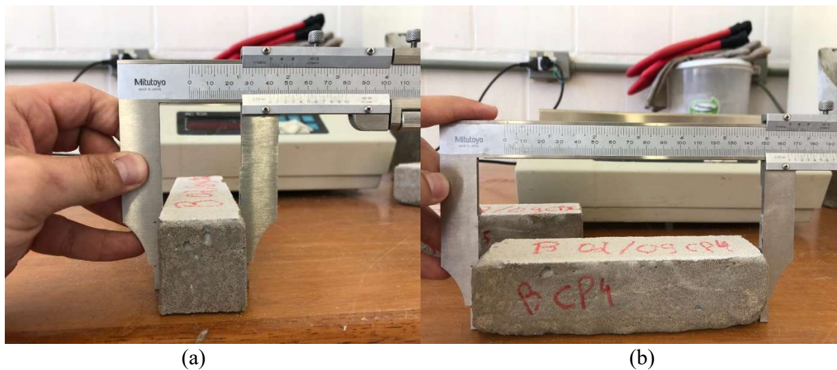
Figura 25 – Determinação das medidas reais dos corpos de prova com auxilio de paquímetro
