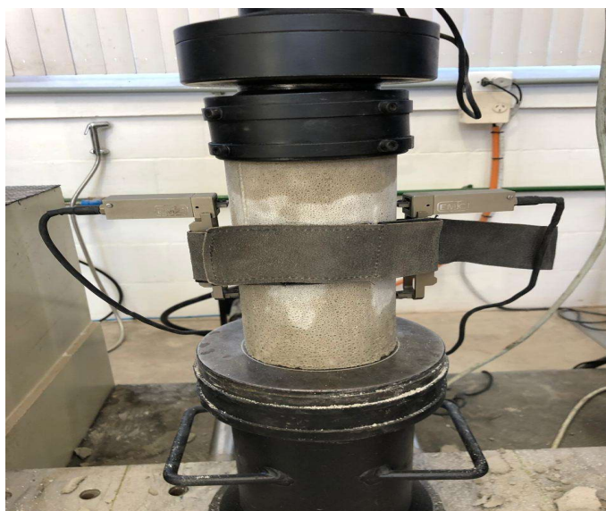
Figura 20 – Extensômetro utilizado para medir a deformação do corpo de prova
