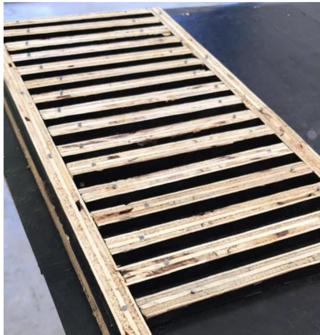
Figura 27 - Forma utilizada para moldar corpos de prova para o ensaio de elasticidade
