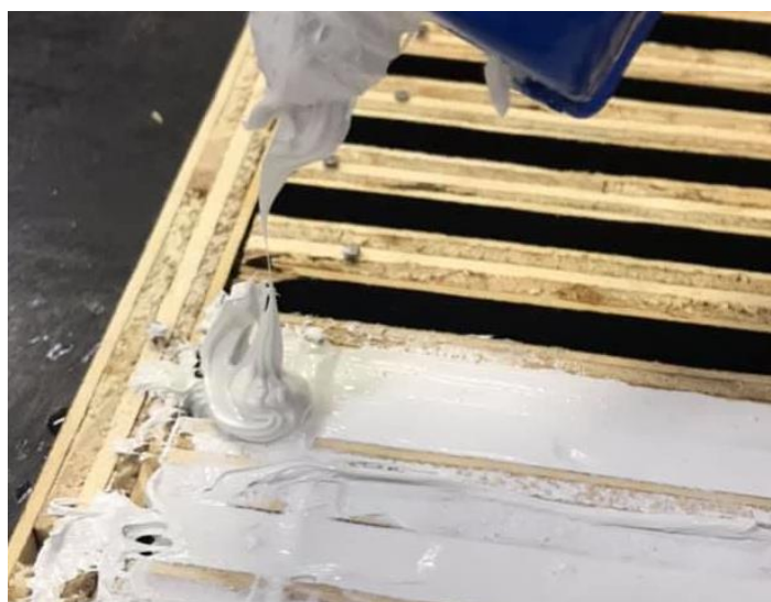
Figura 30 - Análise fio de corte adequado - selante MS
