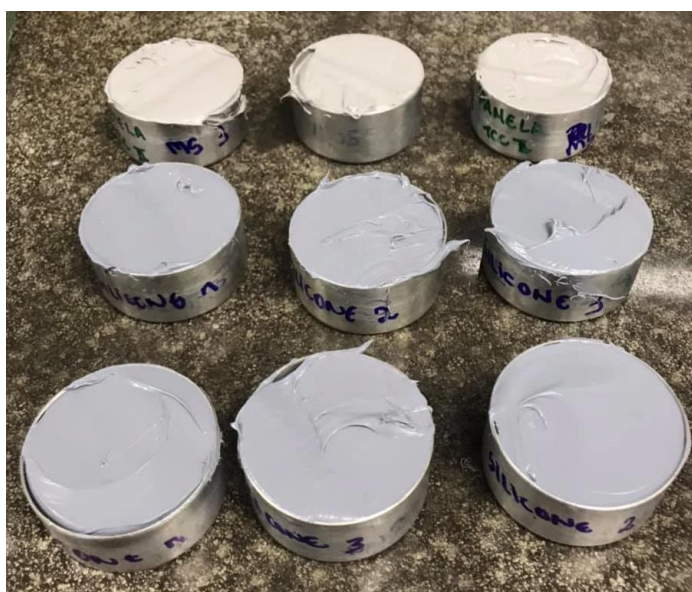
Figura 33 - Preenchimento dos anéis metálicos com os selantes
