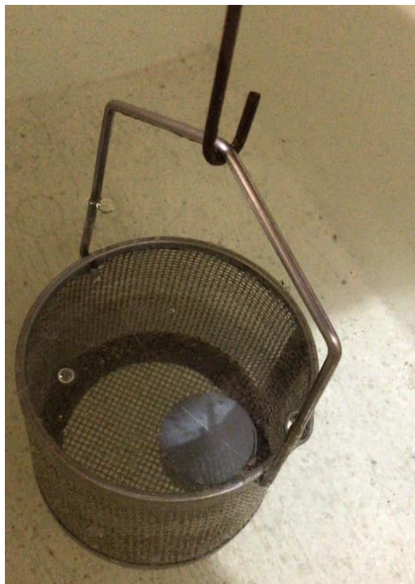
Figura 35 - Anel metálico preenchido com selante pesado em água, em balança com precisão de 0,01g
