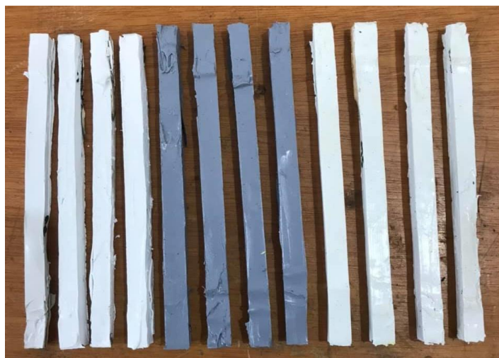
Figura 28 - Preenchimento de selante na forma
