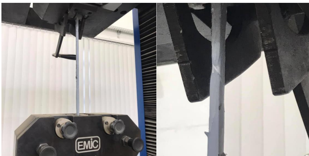
Figura 39 - Selante PU preparado para ensaio de tração
