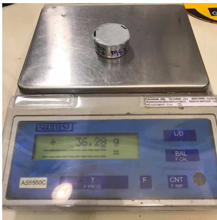
Figura 34 - Anel metálico preenchido com selante pesado no ar, em balança com precisão de 0,01g
