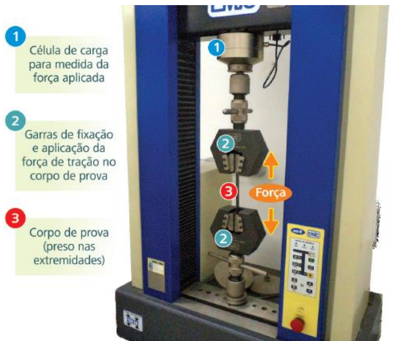
Figura 24 - Máquina de ensaio universal preparada para ensaio de tração
