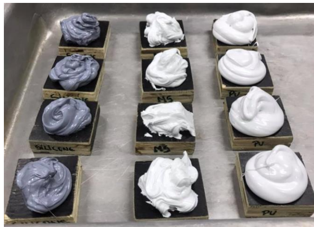
Figura 20 - Corpos de prova moldados para o Ensaio de Dureza Shore A
