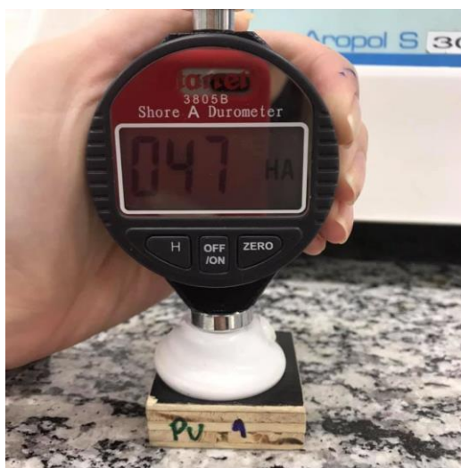
Figura 21 - Execução do ensaio de Dureza Shore A
