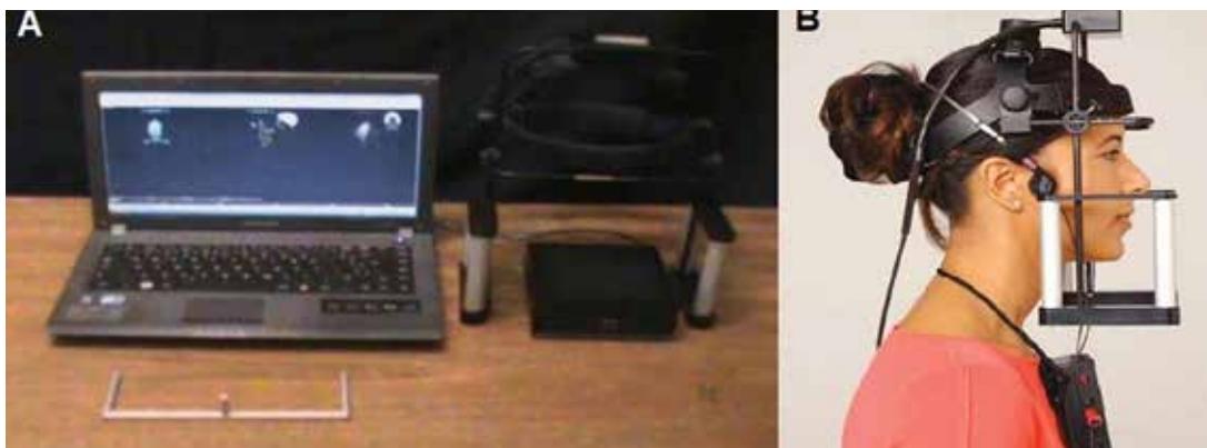
Figura 1 - Eletrognatógrafo JT-3D adaptado ao sistema de software (A) e Suporte de cabeça do Eletrognatógrafo (B)
