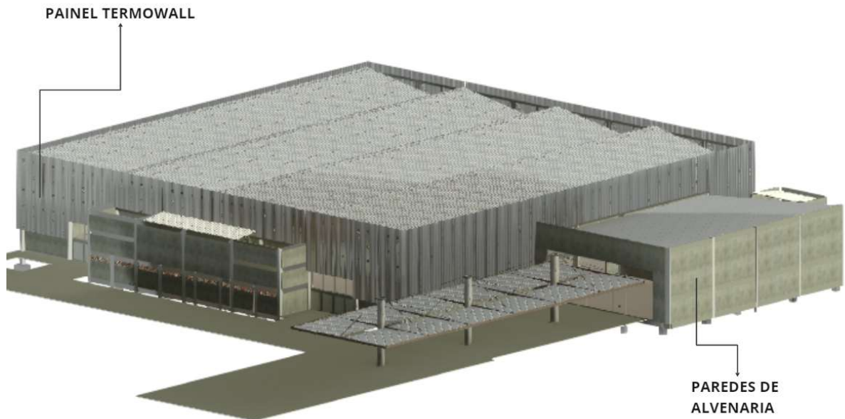
Figura 26 - Paredes de alvenaria e revestimentos externos
