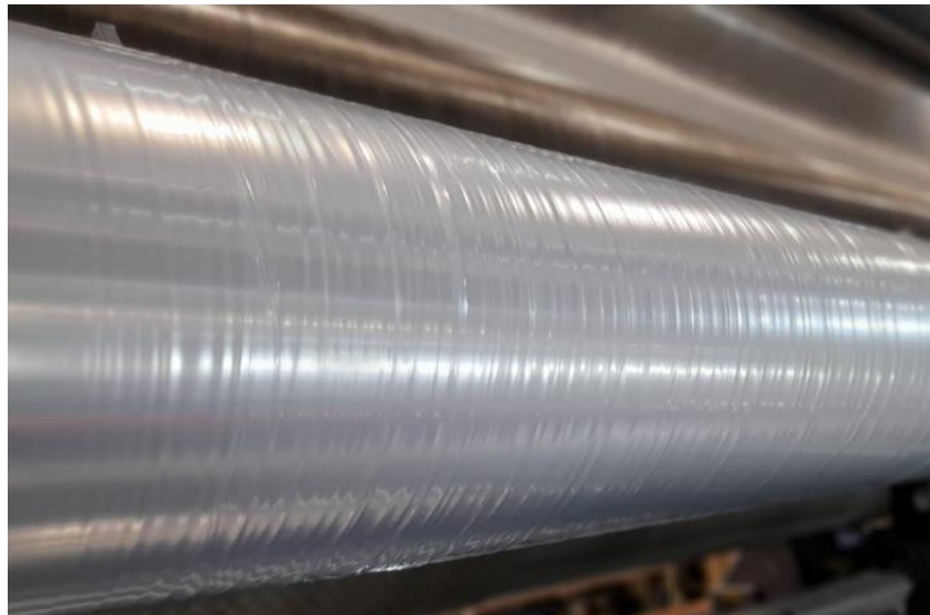
Figura 20 – Imagem de rugas na bobina
