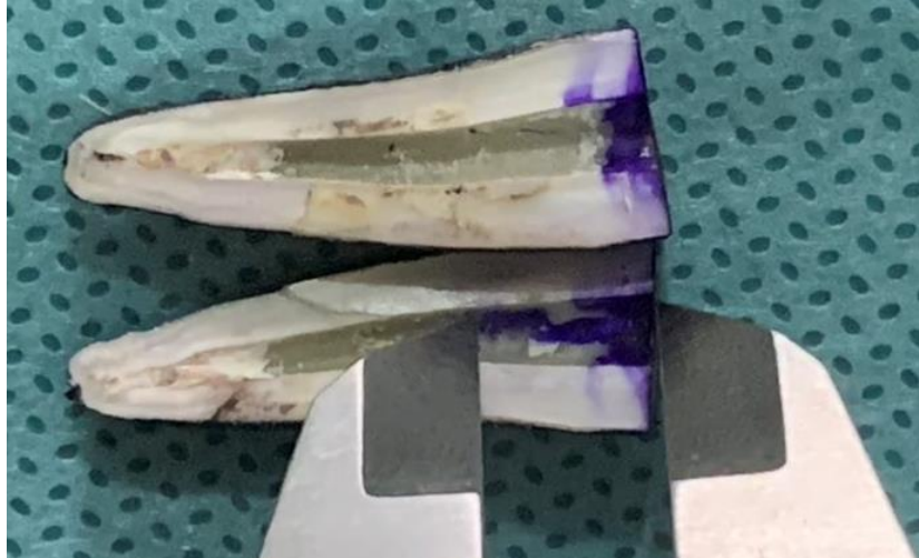
Figura 17. Infiltração presente em fatias do mesmo corpo-de-prova.
