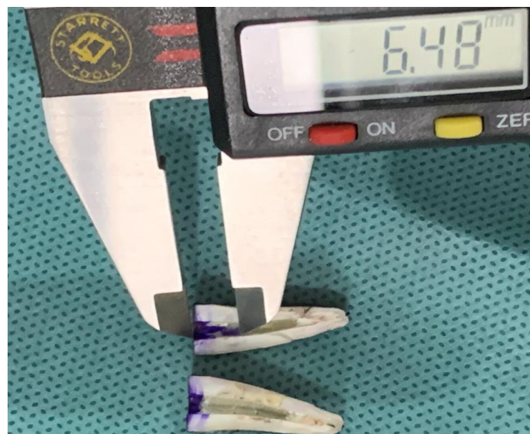
Figura 15 e 16. Método de avaliação dos corpos-de-prova, pino de fibra de vidro reembasado e não reembasado respectivamente.
