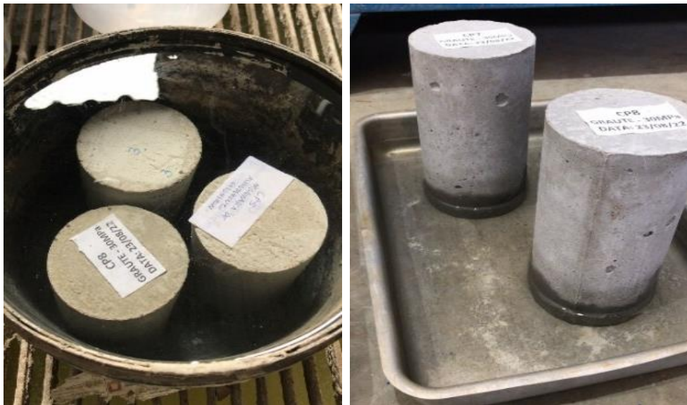
Figura 29 – Ciclos de molhagem e secagem do graute
