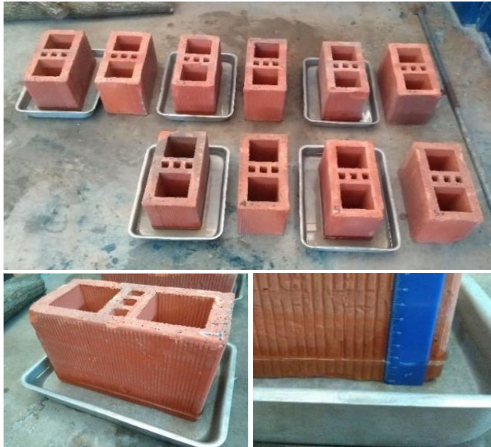
Figura 25 – Blocos dispostos nos recipientes impermeáveis
