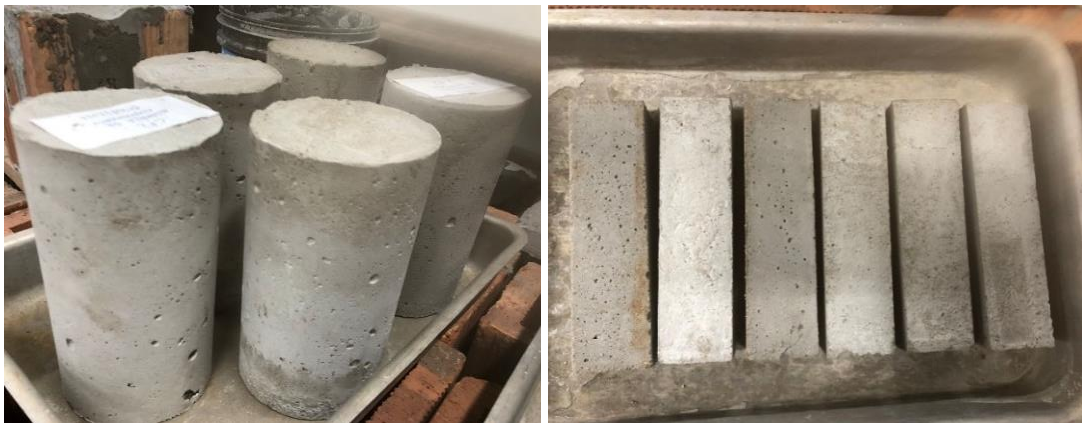
Figura 35 – Corpos de prova desmoldados aguardando a lâmina de água
