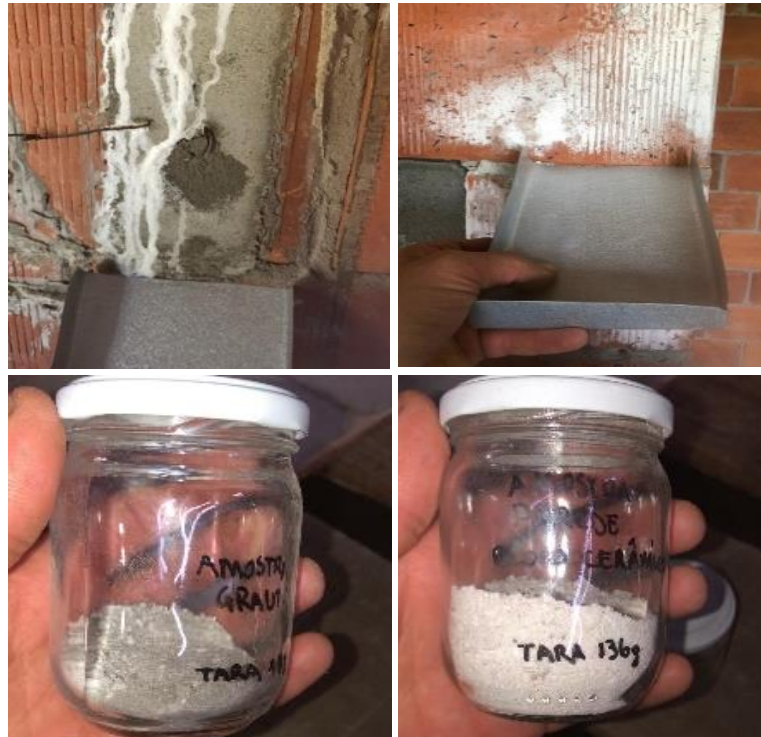
Figura 45 – Raspagem e coleta das amostras
