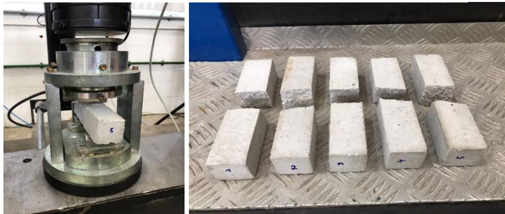
Figura 37 – Rompimento das barras prismáticas de argamassa
