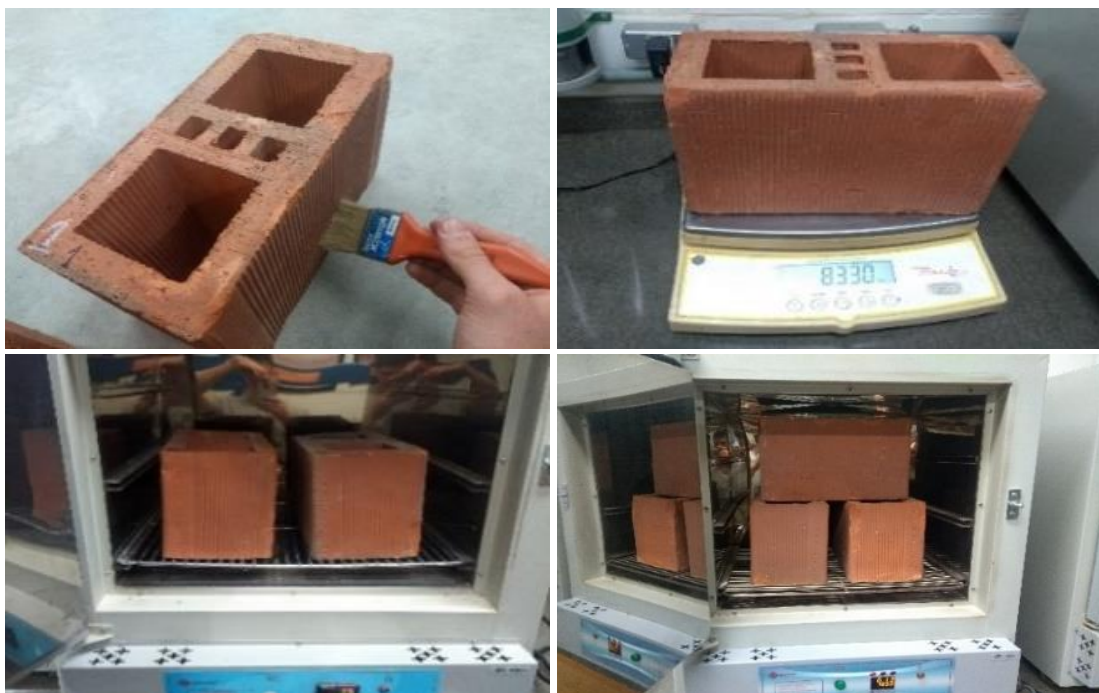
Figura 24 – Limpeza, pesagem e blocos na estufa
