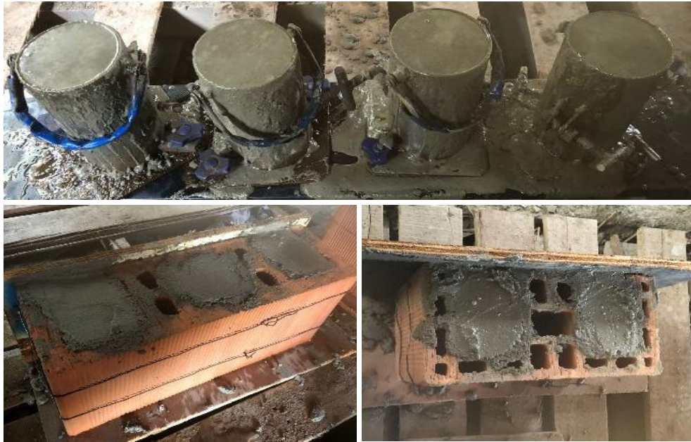
Figura 30 – Moldagem de corpos de provas
