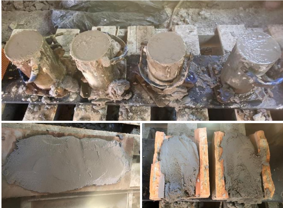
Figura 36 – Nova moldagem de corpos de prova
