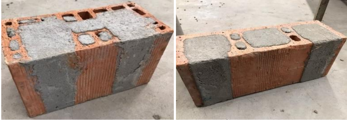
Figura 32 – Corpos de prova com graute curados
