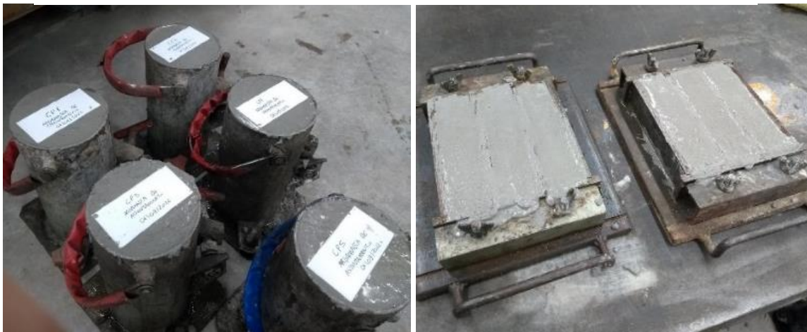
Figura 34 – Moldagem dos corpos de prova de argamassa de assentamento
