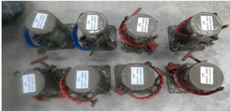
Figura 27 – Graute moldados em formas metálicas
