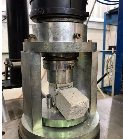
Figura 38 – Rompimento à compressão das barras prismáticas de argamassa
