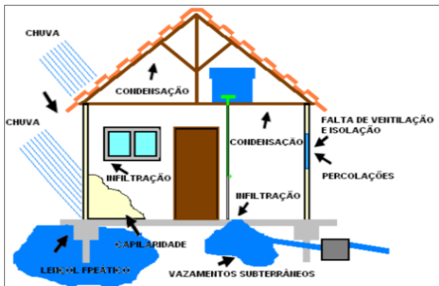
Figura 17 – Formas de ingresso de água na edificação
