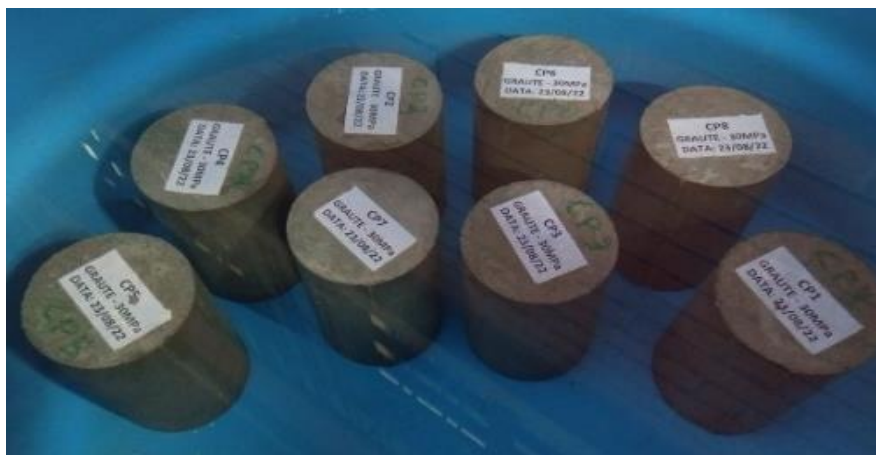
Figura 28 – Corpos de prova submersos em água para cura
