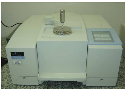
Figura 26 - Espectrômetro FT-IR. Fonte: Adquirida pela autora.
