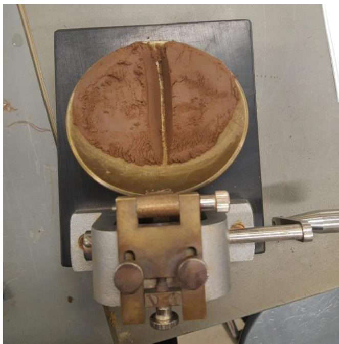
Figura 14 – Amostra de solo na concha do equipamento de Casagrande
