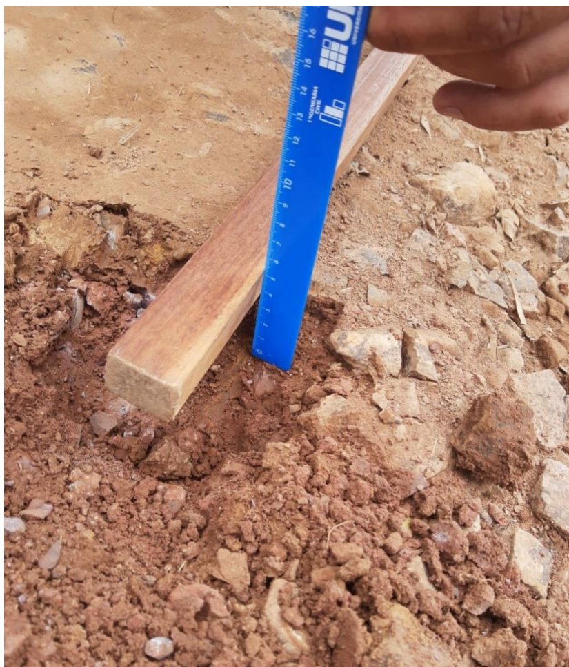
Figura 25 – Método de inspeção de espessura de cascalho em campo
