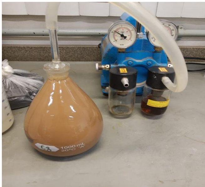
Figura 16 – Conjunto Picnômetro na bomba de vácuo
