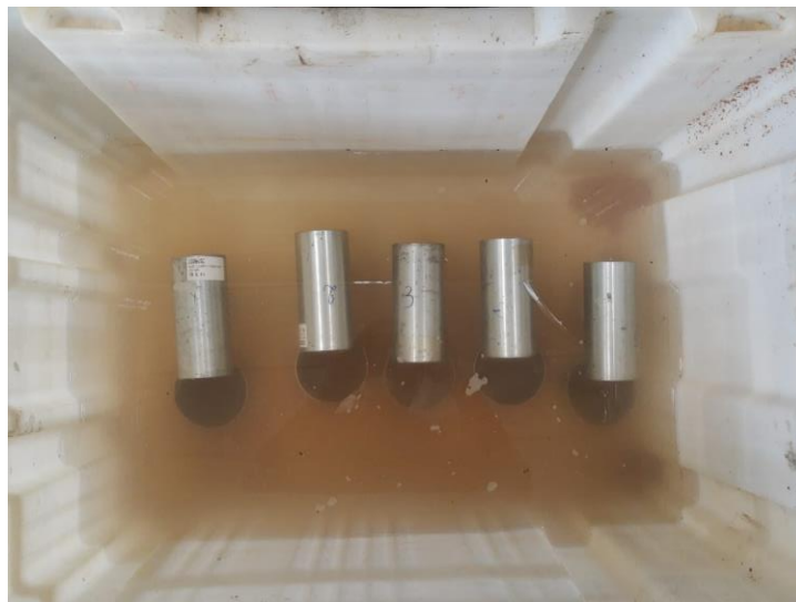
Figura 18 – Ensaio de perda de massa por imersão
