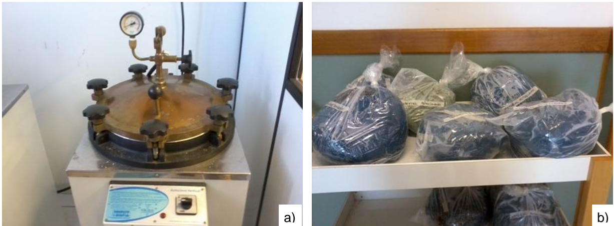
Figura 18: a) Autoclave utilizado para desinfecção do composto. b) Amostras após autoclavagem. Fonte: Registro fotográfico feito pelo autor.
