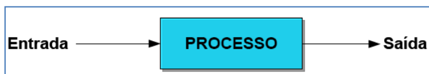
Figura 3 – Diagrama de representação de um sistema de controle.
