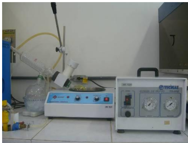
Figura 18. Processo de evaporação do álcool metílico nas amostras de biodiesel. Fonte: Autor, 2011.
