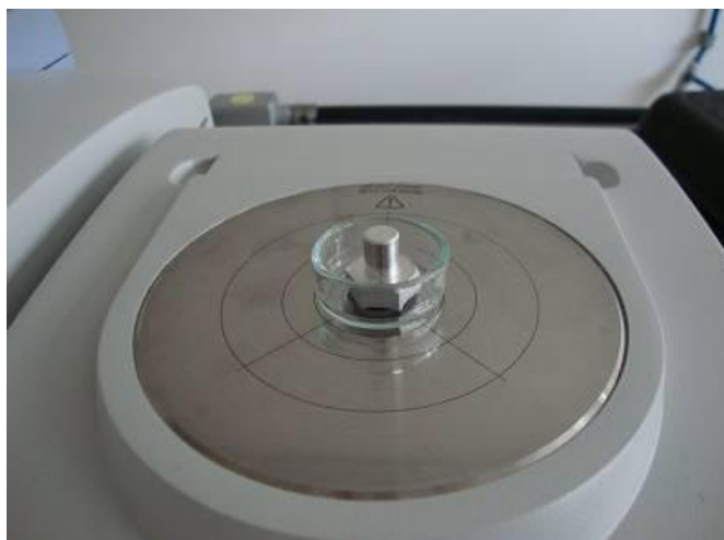
Figura 21. Placa de vidro e acessório de alumínio para a aquisição da leitura do branco. Fonte: Autor, 2011.
