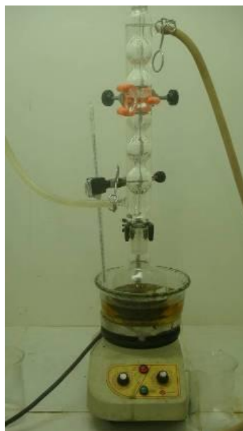
Figura 16. Processo de obtenção das amostras de biodiesel. Fonte: Autor, 2011.
