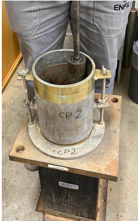
Figura 25 - Compactação do solo no cilindro.
