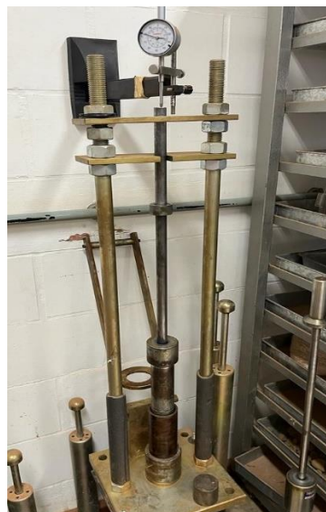
Figura 28 - Corpo de Prova no aparelho Mini-MCV.
