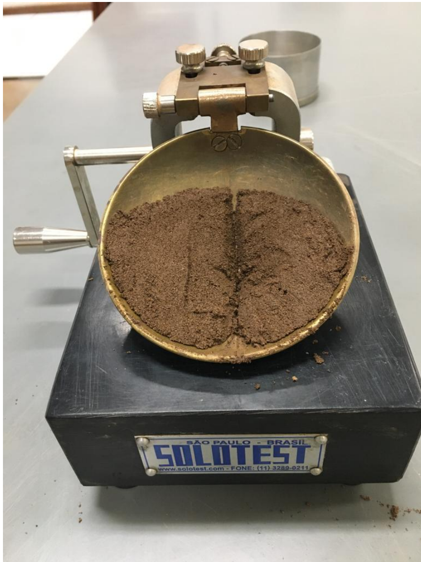
Figura 23 - Solo com a ranhura no aparelho de Casagrande.
