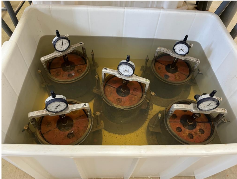
Figura 26 - Corpos de prova submersos no tanque de água.
