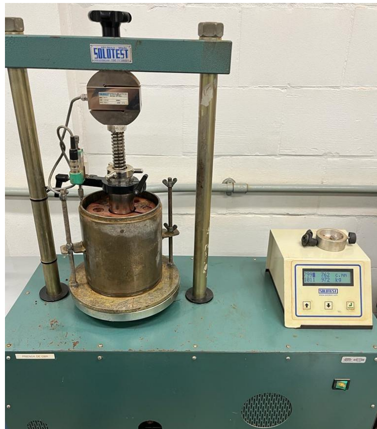
Figura 27 - Corpo de Prova sendo rompido na prensa CBR.
