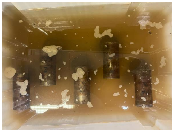
Figura 29 - Corpos de Prova submersos no tanque.
