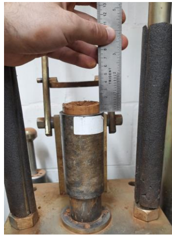
Figura 19 - Extrusão parcial dos CPs
