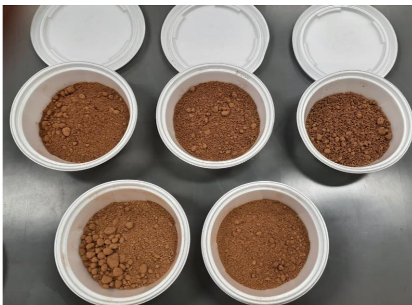
Figura 12 - Porções de 300g após receberem a umidade definida
