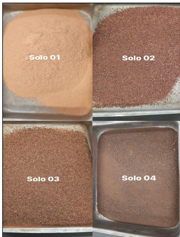
Figura 7 – Amostras dos solos analisados na pesquisa já destorroadas e passadas na peneira de 2mm
