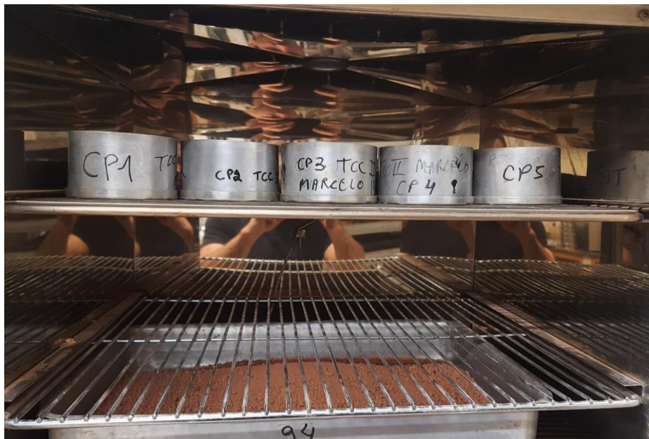
Figura 21 - Determinação da massa seca desprendida
