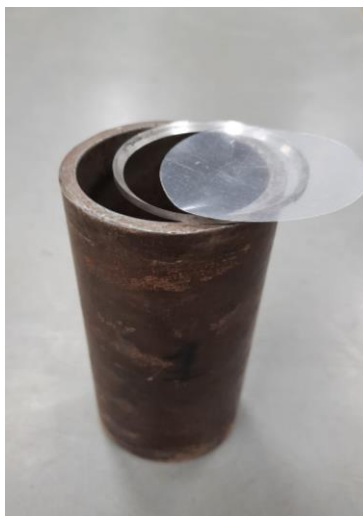
Figura 16 - Corpo de prova com anel de vedação e disco de polietileno
