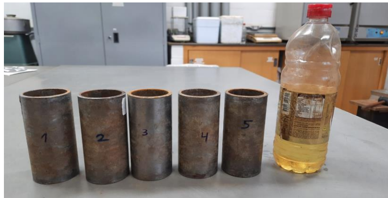
Figura 15 – Corpos de prova untados com óleo
