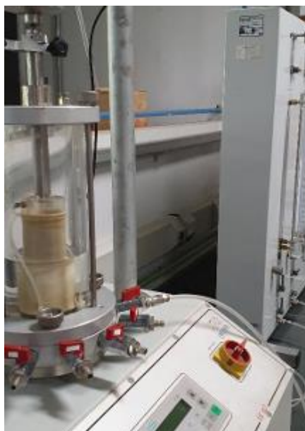
Figura 05 – Enchimento da câmara estática.
