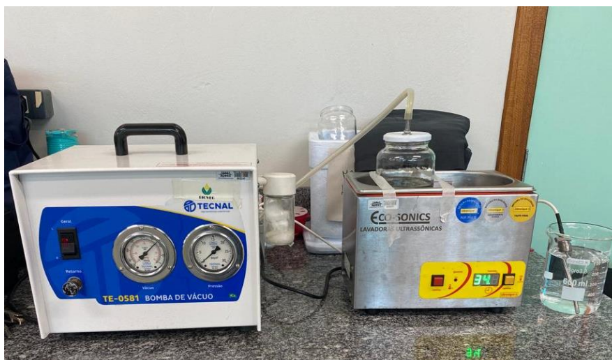
Figura 21 – Ensaio Ultrassom + Vácuo.
