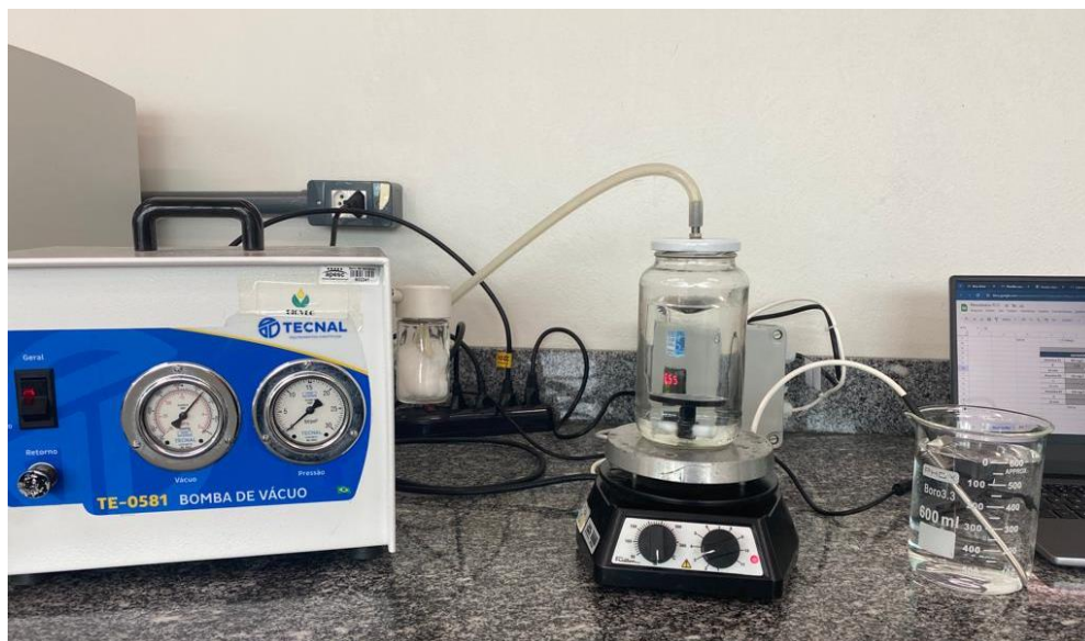
Figura 29 – Ensaio Agitador Adaptado + Vácuo.
