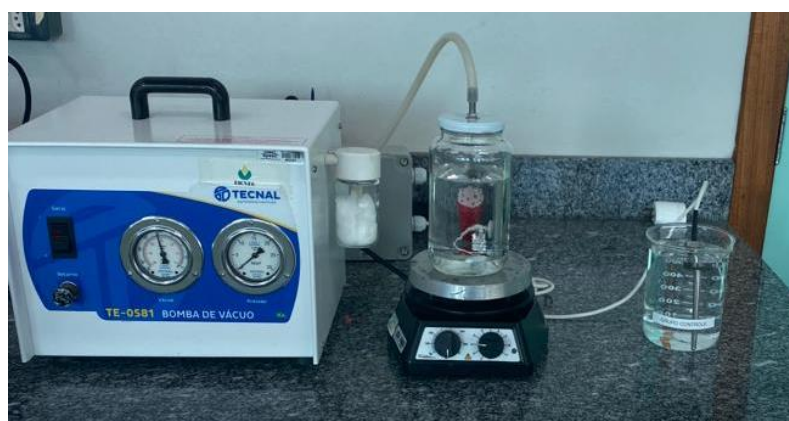
Figura 25 – Ensaio Agitador + Vácuo.
