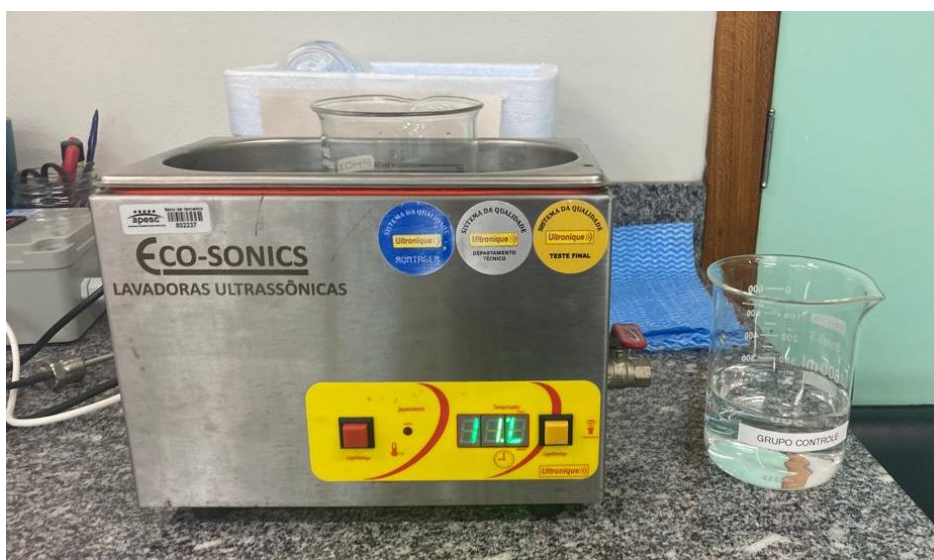
Figura 16 – Ensaio Ultrassom por Imersão.
