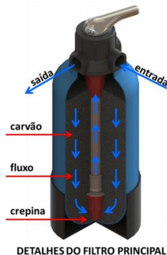
Figura 1 - Filtro de desfluoretação por adsorção proposto por Costa et al. (2018).
